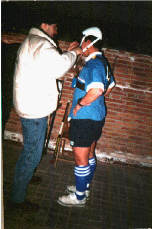
Foto 5-3: Colocación de la turbina del analizador telemétrico (K2-Cosmed) en uno de los jugadores de la muestra.
