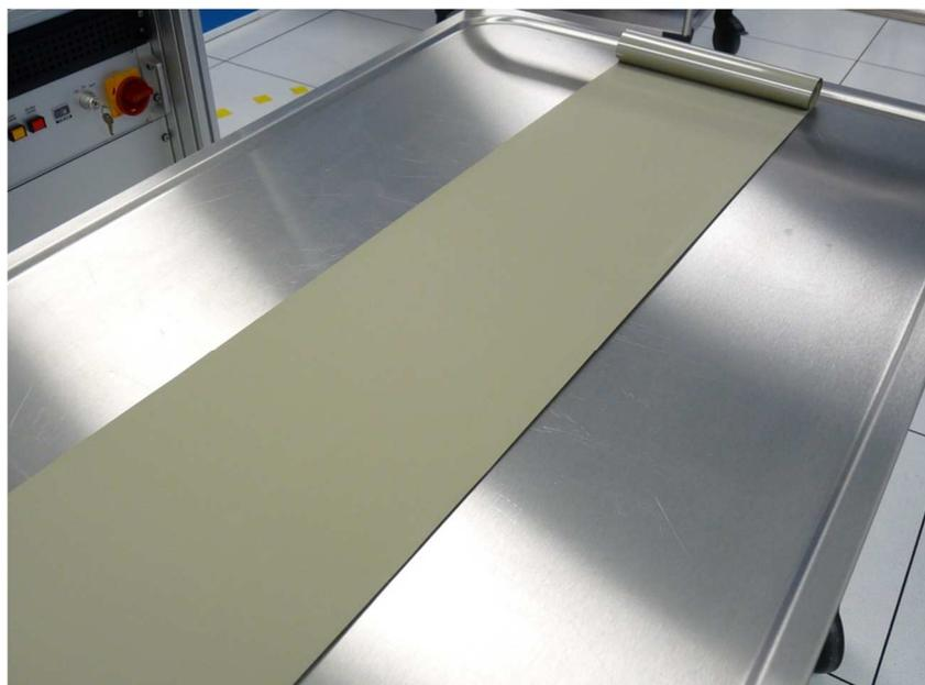
Figura 5. Imagen de cinta de SiC procesada en este Trabajo.
