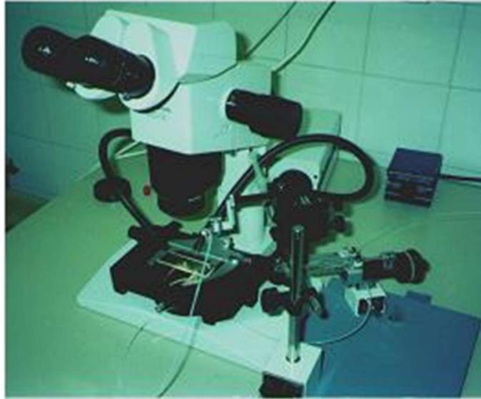
Figura 10. Equipo de dispensación microfluídica.
