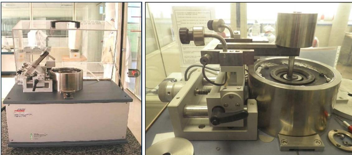
Figura 32. Imágenes del equipo de ensayos tribológicos empleado en el estudio.
