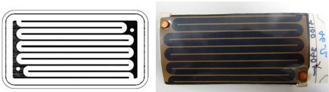
Figura 15. Diseño de los circuitos interdigitados y muestra de uno de los prototipos preparados.
