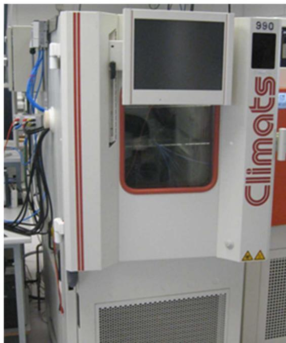
Figura 14. Imagen de la cámara climática utilizada para los ensayos termoeléctricos.
