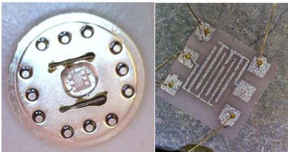
Figura 11. Zocalo de conexión y "wire ball bonding" sobre los pads de Platino.
