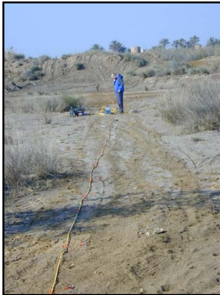
Figura 4.4.6. Equipo de tomografía eléctrica midiendo en la zona de la Rambla del Beal.
