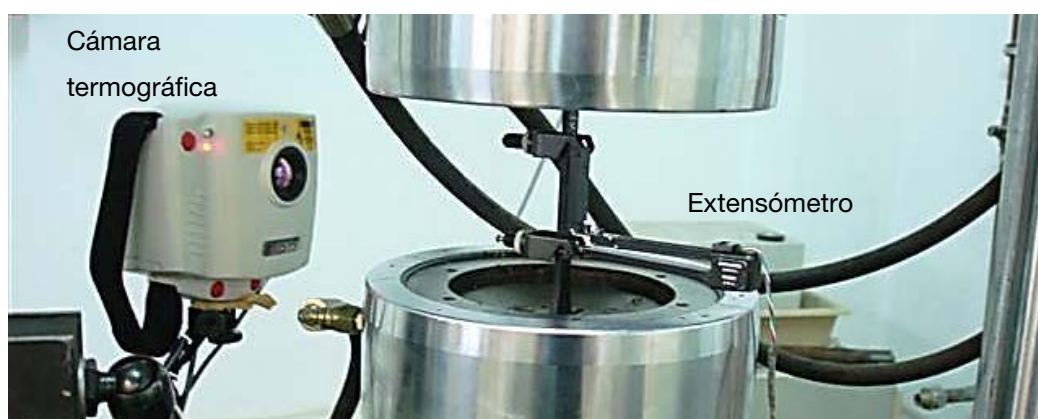
Figura 3.23.- Instrumentación del ensayo de fatiga acelerada LOCATI
