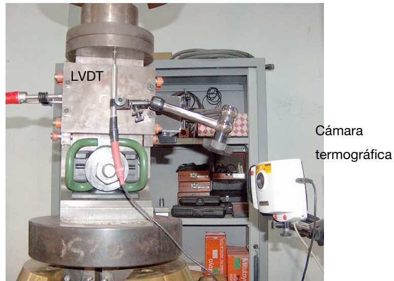
Figura 3.56.-Instrumentación del ensayo de fatiga acelerada LOCATI
