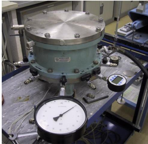
**Figura 1. Calibración de los sensores de presión total de la columna**
