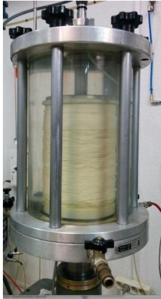
**Figura 3.9. Celula triaxial con muestra de grava reforzada con geotextil**
