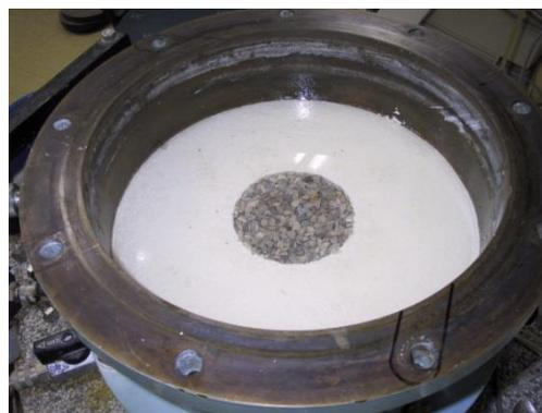
**Figura 2.18. Vista de la columna y el caolín justo antes de la aplicación de la presión a la cual se consolidan, 100kPa**
