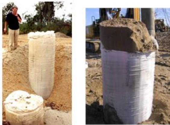
**Figura 1.16. Pruebas con columnas ensacadas geotextil Ringtrac. Alexiew et al. (2005)**
