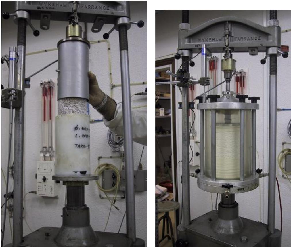
**Figura 8. Extracción y montaje de la probeta de grava para ensayo triaxial**
