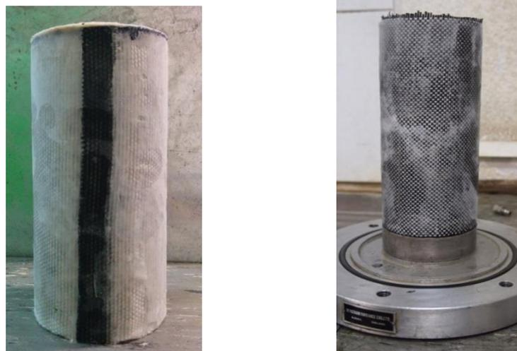
**Figura 3.8. Columna de grava reforzada para ensayos triaxiales**
