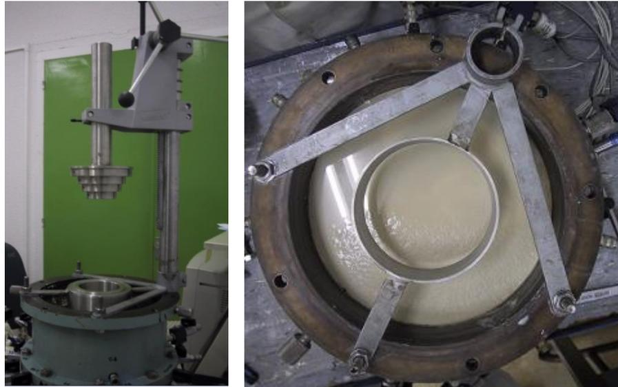
**Figura 2.17. Sistema para el hincado de la columna**
