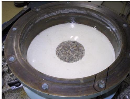
**Figura 3.19. Vista de la columna y el caolín antes del ensayo**
