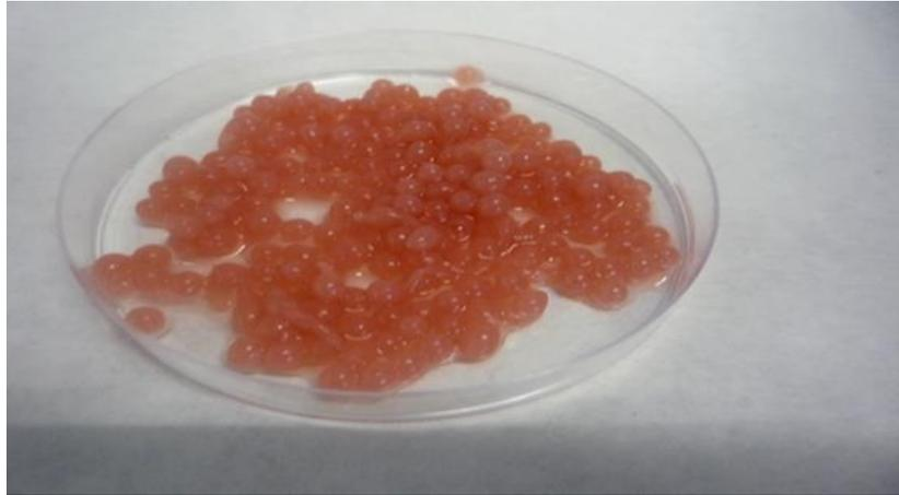
**Figura 3.6** Esferas de alginato/cacao preparadas por extrusión y gelificación externa.
