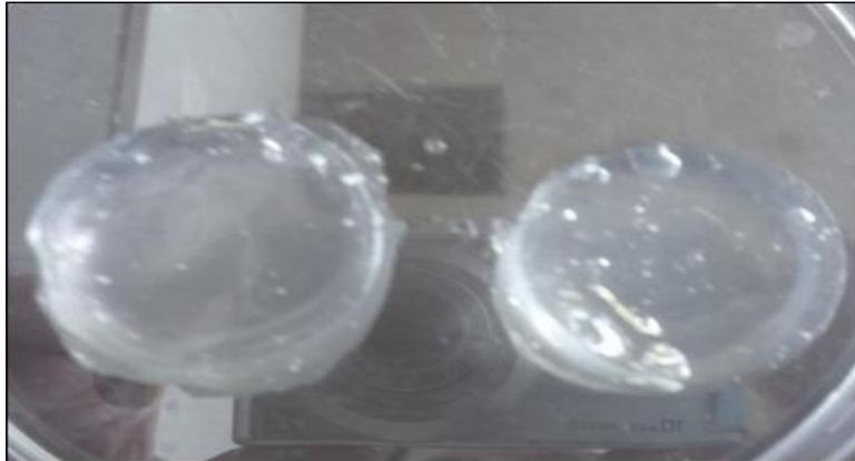
**Figura 3.1** Aspecto de los geles de alginato cálcico preparados por GE con diferentes concentraciones de calcio a partir de soluciones acuosas de  $\text{CaCl}_2$  a 25 °C.
