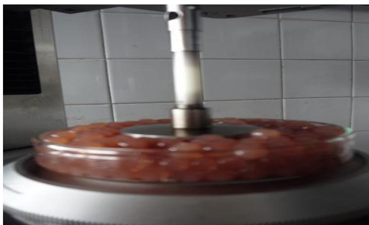
**Figura 3.8** Esferas preparadas por extrusión para el análisis de textura.
