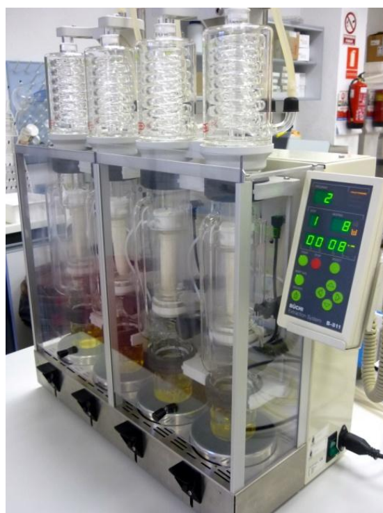
Figura III.13. Extractor tipo Soxhlet utilizado para el proceso de extracción de fenoles en carne.
