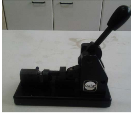
Figura 3.31. Troquel para la obtención de muestras circulares de 3 mm de diámetro.
