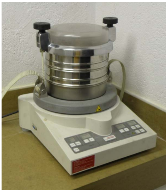
Figura 3.2. Tamizadora Fritsch Analysette 3 empleada para el tamizado del polvo inicial.
