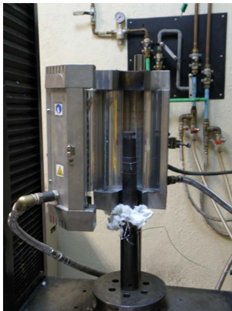
Figura 3.8. Sistema de compactación en tibio. Máquina de ensayos universal Instron 8501 con horno de radiación incorporado.
