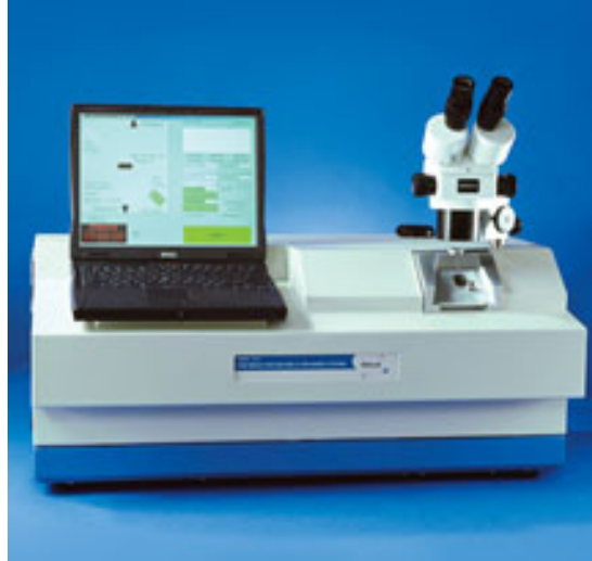
Figura 3.34. Ion Milling para preparación final de muestras TEM.
