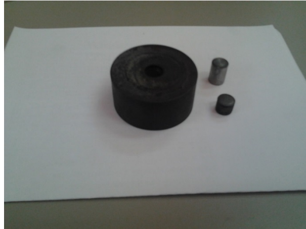
Figura 3.12. Molde y punzones de Molibdeno TZM para realizar los tratamientos Hot Isostatic Pressing (HIP).
