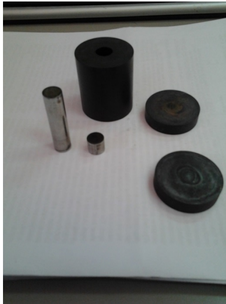
Figura 3.10. Molde y punzones de compactación, acero ICO2800.
