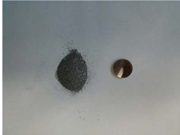
Figura 3.9. Polvo molido previa compactación y compacto de 10 mm de diámetro.
