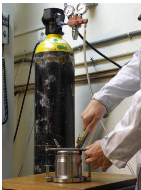
Figura 3.6. Proceso de purgado y llenado de argón de los viales de molienda.
