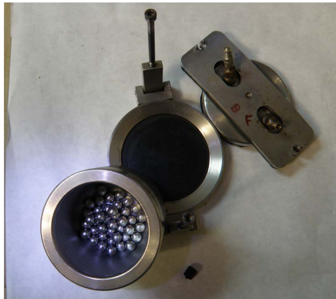
Figura 3.4. Interior de un recipiente y elementos de molienda de acero templado al cromo.
