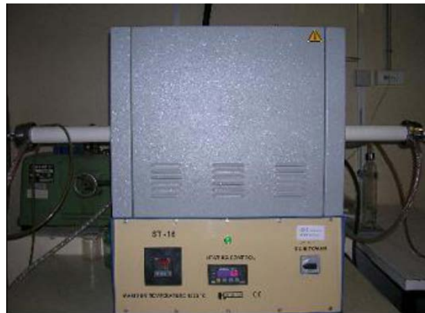
Figura 3.11. Horno tubular de la empresa Hobersal, modelo ST16.
