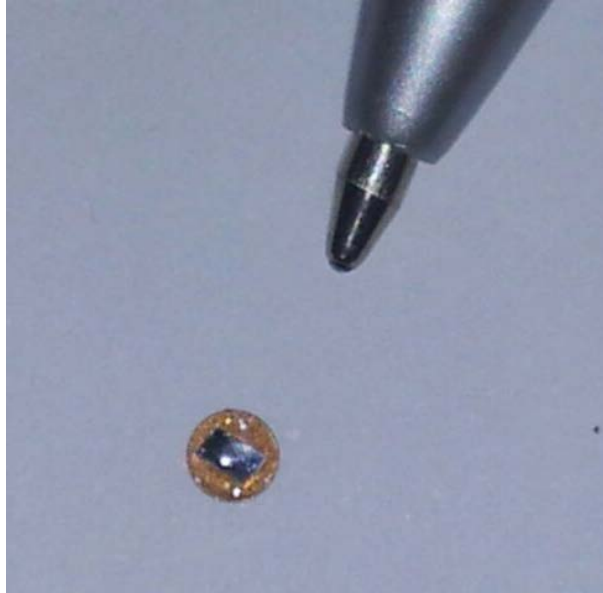
Figura 3.33. Muestra cortada y colocada en un portamuestras de cobre para microscopio TEM.
