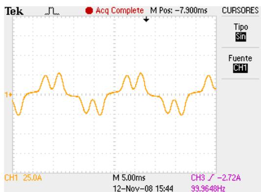
Figura 4-15 Corriente de carga con la reducción de reactiva activada ( $K_H=0,29$ )
