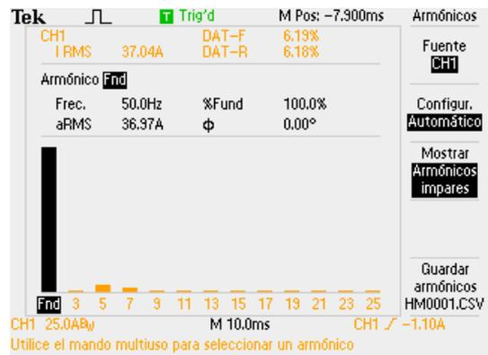
Figura 4-14 Armónicos en la red con la reducción de reactiva activada (Figura 4-12)
