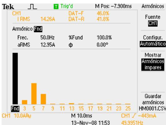
Figura 4-9 Armónicos en la carga con toda la reactiva (Figura 4-7)
