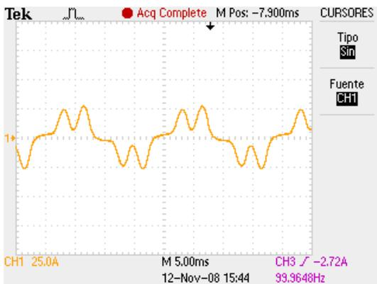
Figura 4-7 Corriente de carga
