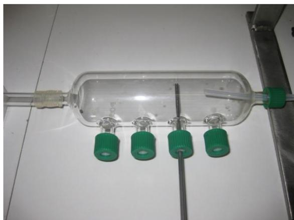
Figura 3.18. Manifold para la toma de muestra
