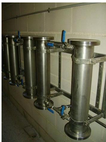
Figura 3.10. Detalle de los seis cilindros de acero inoxidable del sistema de purificación del aire matriz fabricados en el Taller Mecánico del SACE de la Universidad de Murcia.
