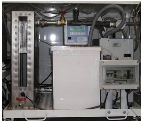
Figura 3.14. Baño termostático para el acondicionamiento del agua destilada de humidificación.
