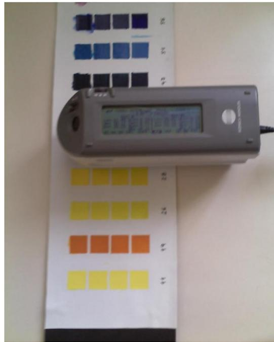
Figura 3.32. Medición del color en las muestras.
