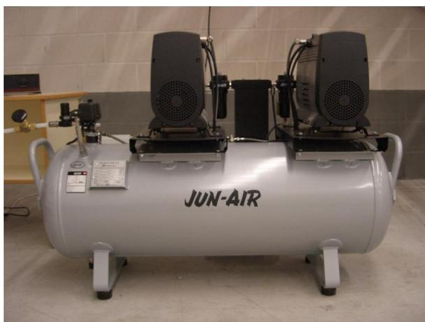
Figura 3.9. Vista delantera del compresor Jun-Air 2OF1202-150BD6.
