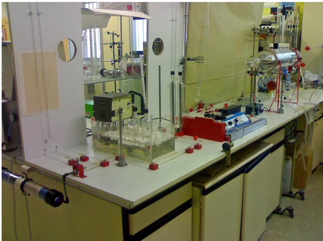
Figura 3.7. Sistema dinámico de atmósfera controlada de ácido nítrico.
