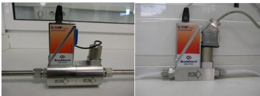
Figura 3.15. Controlador-medidor másico *BRONKHORST HIGH-TECH*. Izquierda: 0-0,4 l<sub>N</sub>/min; Derecha: 0-150 l<sub>N</sub>/min.
