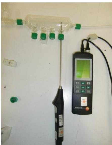
Figura 3.16. Termohigrómetro *TESTO* modelo 645.
