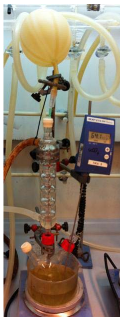
Figure 2.15. Montage à reflux sous atmosphère inerte (ballon d'azote).
