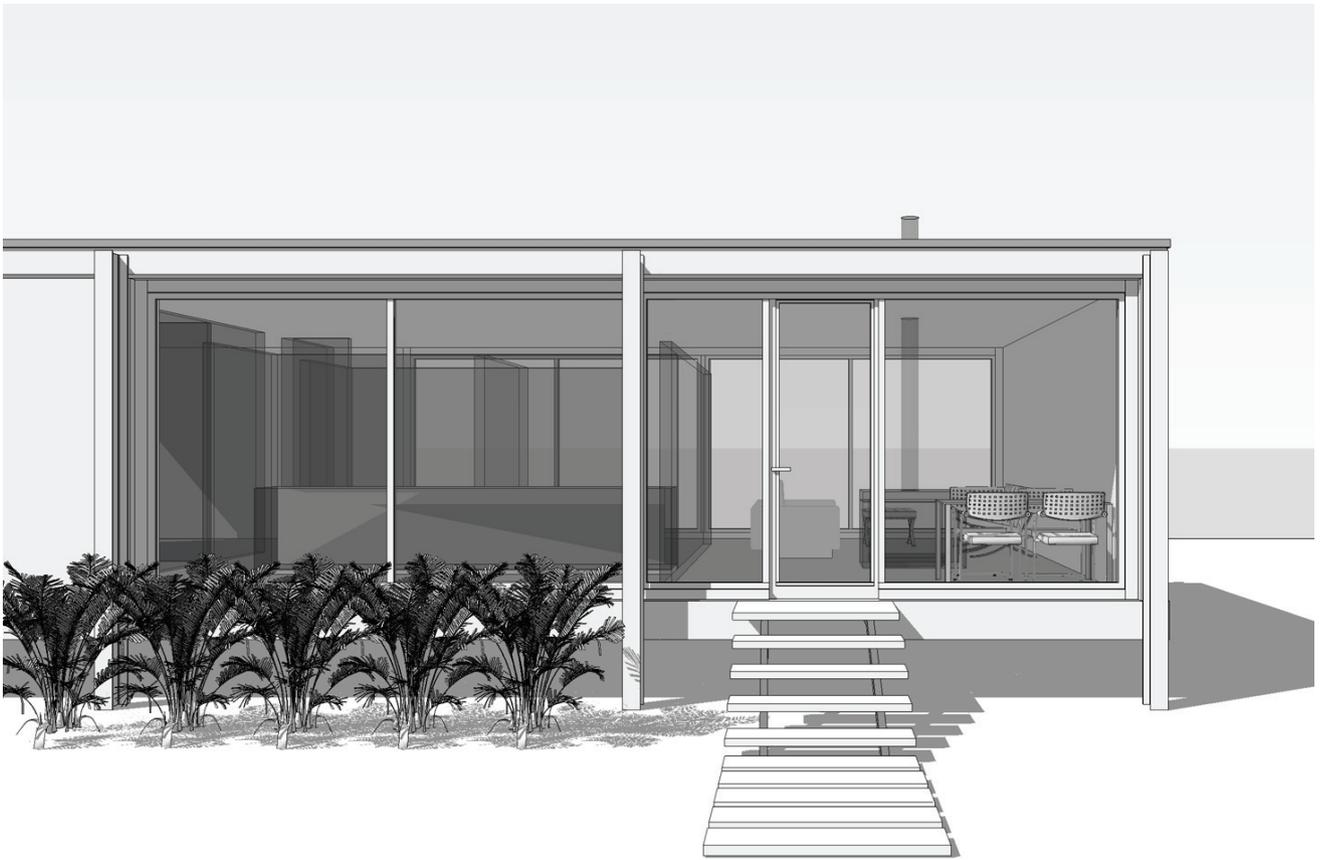
*Imagen exterior de la sala de estar y el módulo de servicios. La estructura exterior se resuelve con perfiles metálicos. El cerramiento vidriado es el que sugiere la planta del croquis original.*
