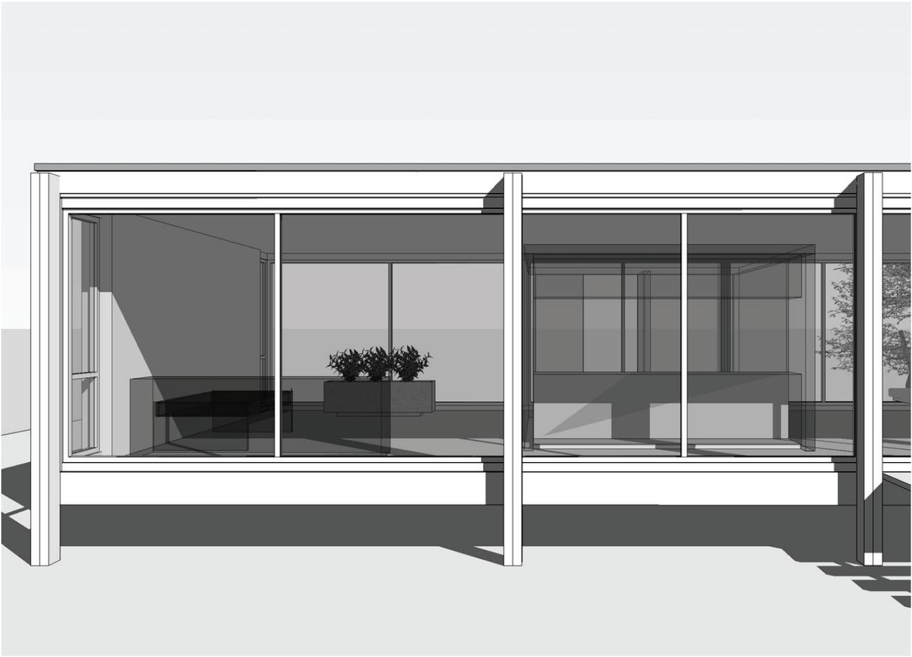
*Imagen exterior del acceso a la vivienda. La estructura exterior se propone con elementos verticales de sección rectangular, según el propio croquis.*
