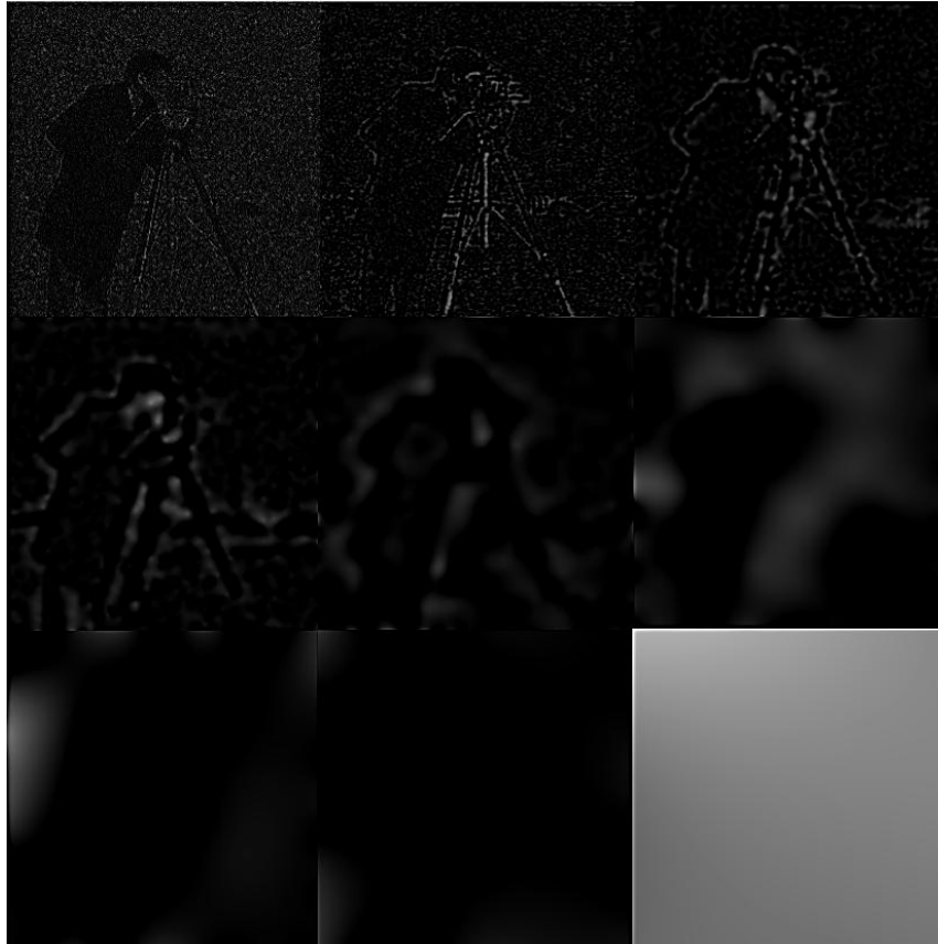
Figura 47 Imatge amb soroll descomposada amb l'Empirical mode decomposition
