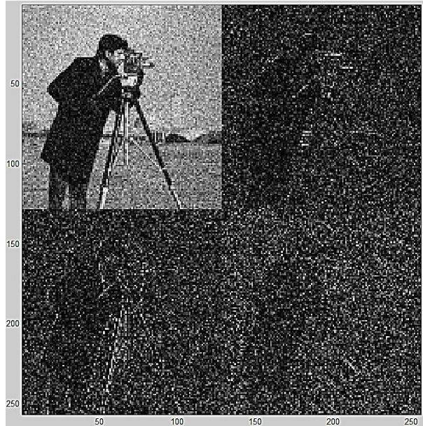
Figura 35 Transformada Wavelet discreta 2D de nivell 1 fent servir el Wavelet Daubechies 1
