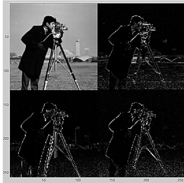
Figura 33 Transformada Wavelet discreta 2D de nivell 1 fent servir el Wavelet Daubechies 1
