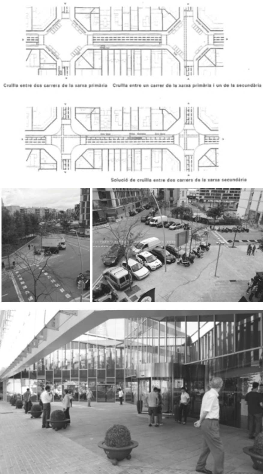
Fig.4.26. Chanfros do plano de infraestruturas do 22@. Fig.4.27. e 4.28. Chanfros de Can Framis e do edificio Media TIC, na Sancho d'Àvila com Roc Boronat, este último notando um ganho de espaço público pela tipologia do edificado – da mesma forma que acontece na Fig.4.29., no Interface Building , um edificio de escritórios- Este forma parte do catálogo patrimonial, mantendo a fachada original da fábrica Netol, dos anos 50, coberta com uma superfície de vidro.
