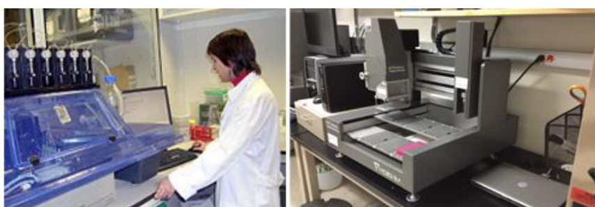
Fig. 3.20. Fotografies del robots fets servir per a la realització d'assajos cristal·logràfics. Cartesian (esquerra) i Phoenix (dreta).
