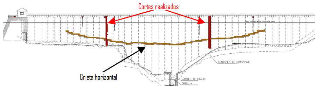
Figura 3.12.- Esquema fisura horizontal paramento aguas abajo (Sbarigia et al. , 2013)
