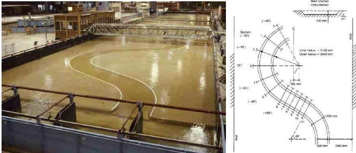
Figura 2.4.15. Vista del FCF durante uno de los ensayos con cauce meandriforme (series B)-izda. Esquema en planta de las secciones de estudio-dcha.
