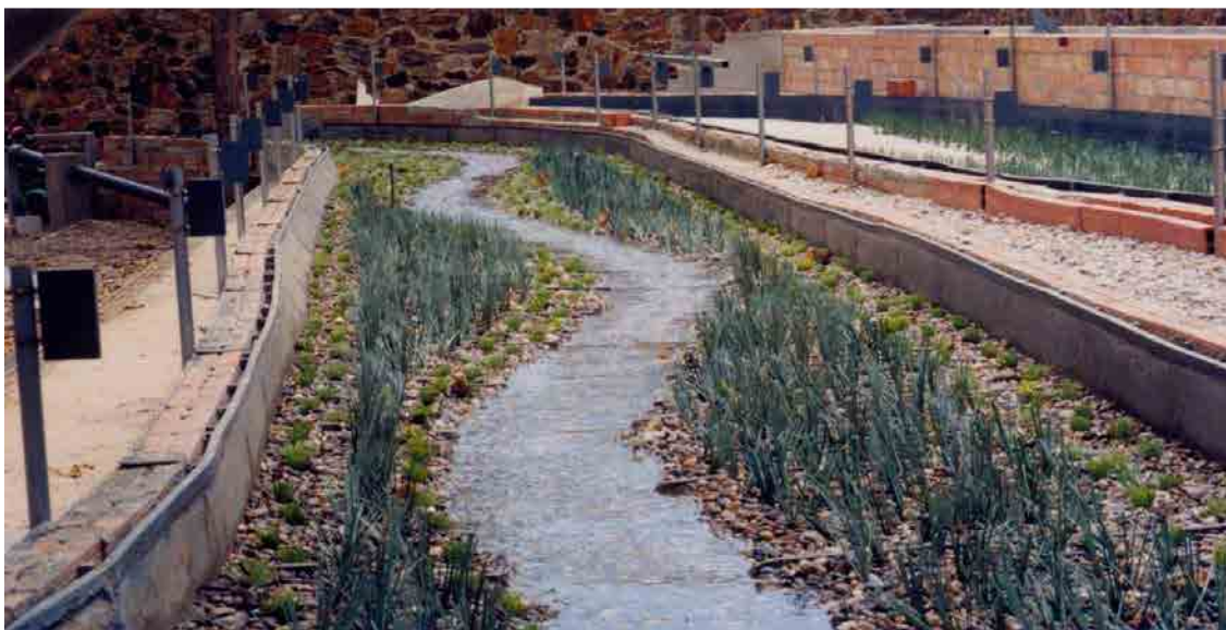
Figura 7.2.5 Fotografía del modelo reducido del río Besòs. La fotografía es ilustrativa del proyecto de restauración, en los ensayos las plantas ocupaban toda la superficie de las llanuras.
