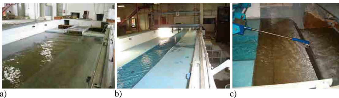
Figura 6.2.1. a) Entrada separada en cauce y llanuras, b) longitud de desarrollo y c) vertido sobre compuerta.
