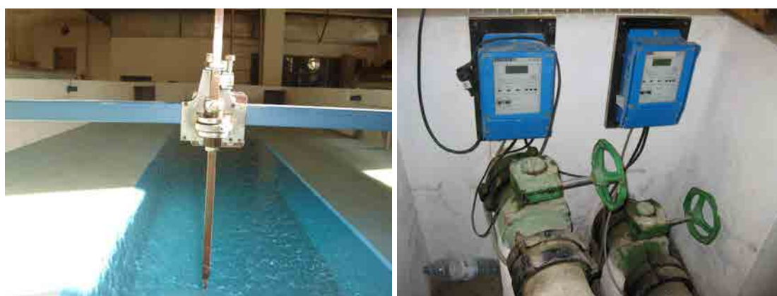
Figura 6.3.1 a) Limnómetro colocado en el centro del cauce y b) Caudalímetros electromagnéticos situados en las tuberías de suministro de agua al modelo.
