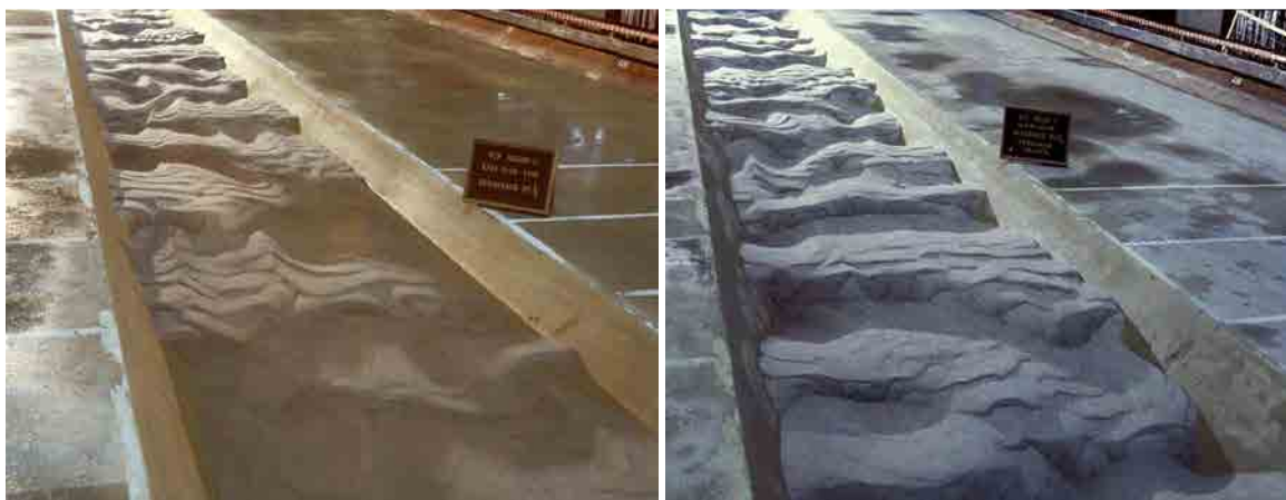
Figura 2.2.26. Formas de fondo en el cauce principal, con flujo a cauce lleno (izda.) y con flujo desbordado sobre las llanuras (drcha.).
