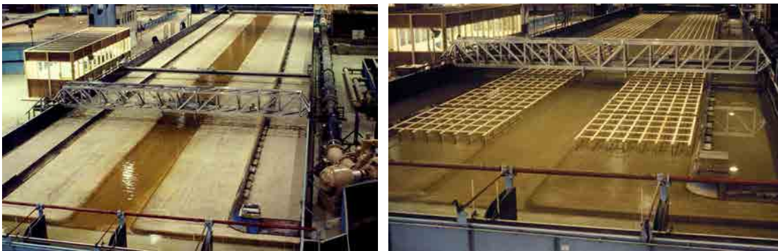
Figura 2.2.12. El canal de avenidas, FCF, localizado en HR Wallingford. Serie 02 con llanuras lisas (izqda.) y Serie 07 con llanuras rugosas (drcha.).
