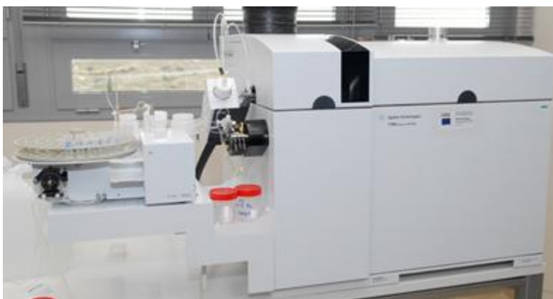
Figura 4.2.9: Espectrómetro ICP-MS THERMO ELEMENTAL
