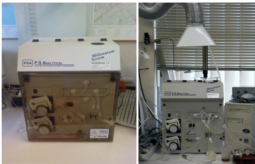
Figura 4.2.8: Equipo GH-AFS, PSA Millennium Merlin 10025 (izq) y PSA Millennium Excalibur 10055 (dcha)
