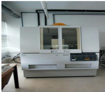
Figura 4.2.3: Difractómetro de Rayos-X Phillips X'Pert
