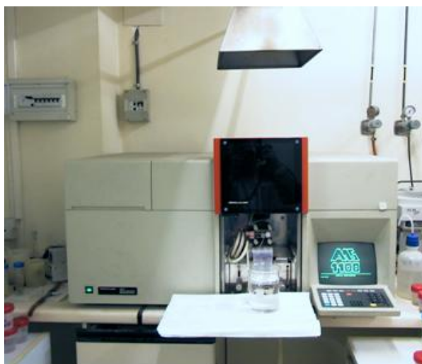
Figura 4.2.6: Espectrómetro Perkin-Elmer 1100B
