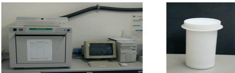
Figura 4.2.5: a) Microondas Milestone ETHOS PLUS, b) Tubo de teflón
