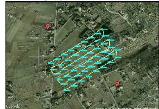
Figura 51. Planificación del vuelo en UAV para volar en vuelo programado. Fuente: [www.menci.com].
