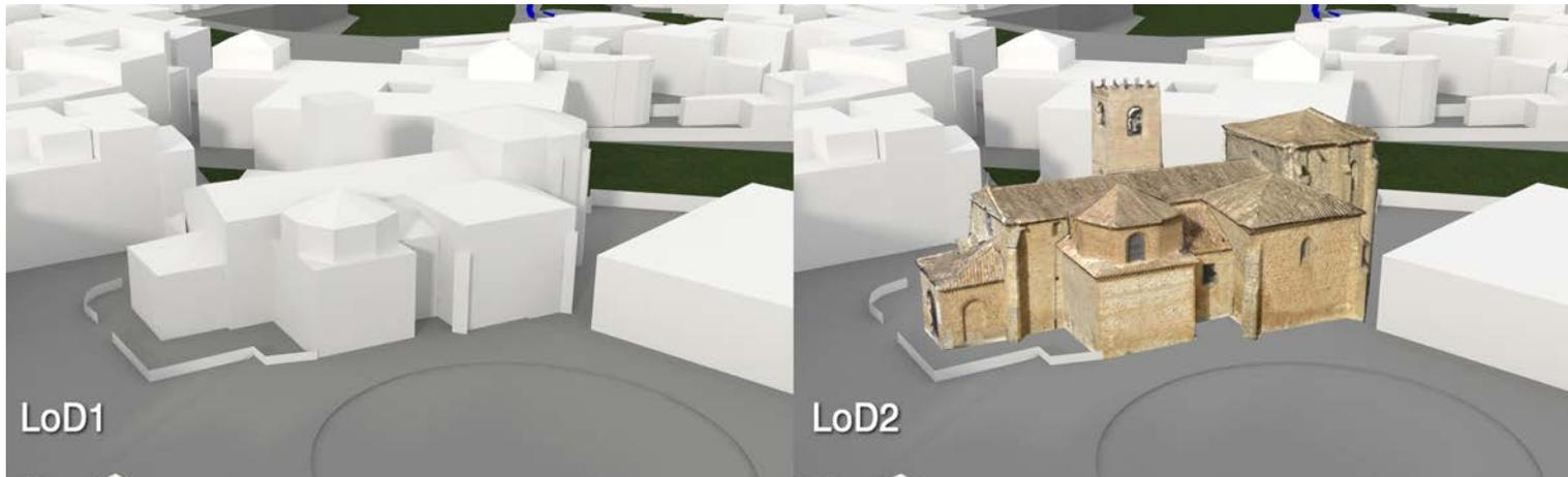
Figura 130. Diferentes tipos de detalle en vista aérea de la iglesia de San Miguel. LoD1 mediante volúmenes prismáticos y alguna alusión a las cubiertas y el LoD2 realizado mediante fotogrametría y simplificado del exterior para alta resolución. Fuente: elaboración propia.
