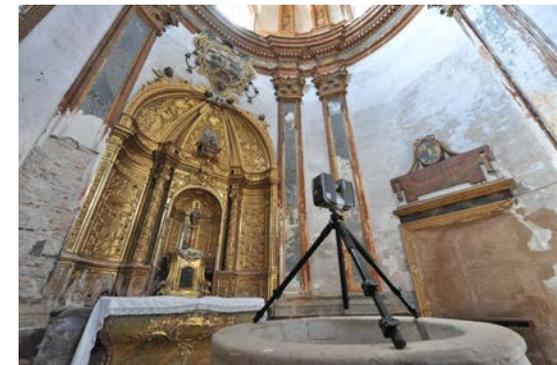
Figura 65. Trabajo de campo con el Faro Focus 3D- Fuente: Faro del Laboratorio de Fotogrametría de Valladolid.
