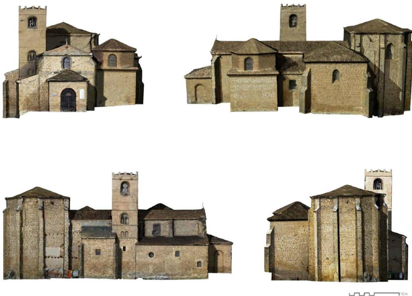
Figura 61. Alzados mediante ortofotografía. Fuente: elaboración propia.
