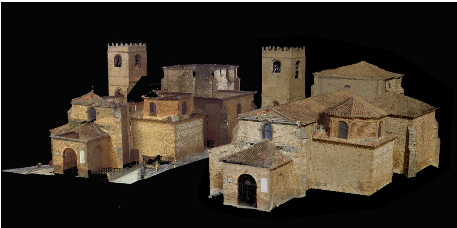
Figura 79. Vista perspectiva del modelo tridimensional realizado con láser escáner (izquierda) y con fotogrametría SfM (derecha). Fuente: elaboración propia.
