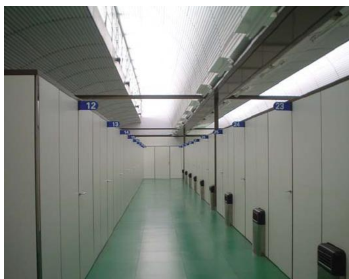
Figura 2.88 – H. Sarah Fortaleza - Vista interior – pasillo cubierto con sheds y vista de rejillas para salida del viento proveniente de las galerías (PERÉN, 2006, pg.190)
