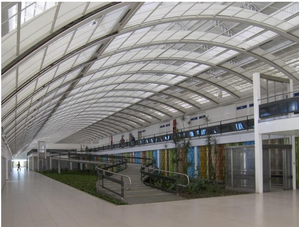
Figura 2.105 – H. Sarah Río de Janeiro - Bloque de hospitalización - vista de jardín interior, pasillo/rampa, acceso a las habitaciones individuales y vista de cubierta de arcos móviles /translúcidos (archivo del CTRS)
