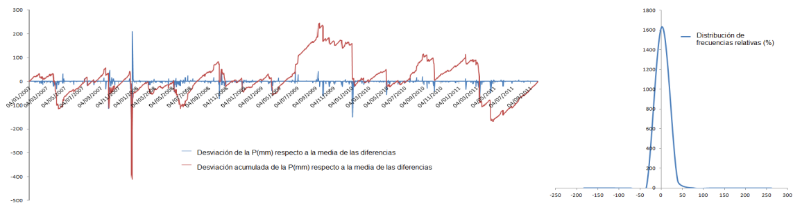
Figura A.4.2.3.c. Desviación de P(\text{mm d}^{-1}) respecto a la desviación media de 1994-2011 (izquierda) e histograma de distribución de frecuencia relativa de lluvias diarias en los días con lluvia (derecha) para el par Mas de Barberans-PN els Ports.
