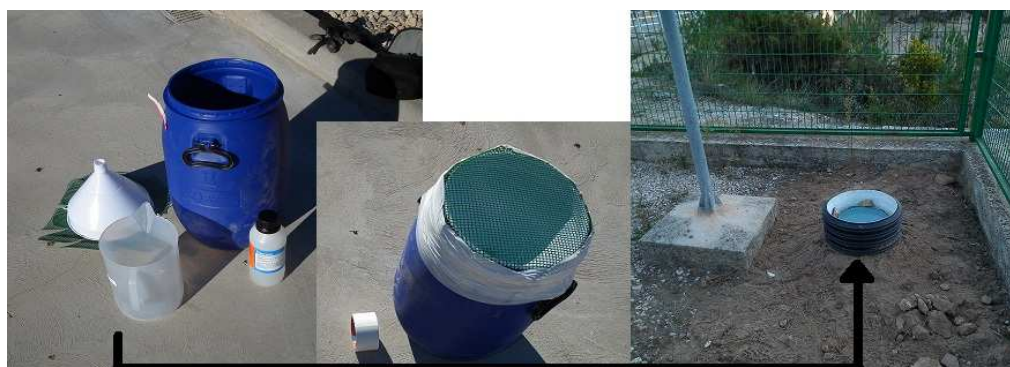
Figura A.2.2.2.b. Proceso de instalación de un colector de agua de lluvia.
