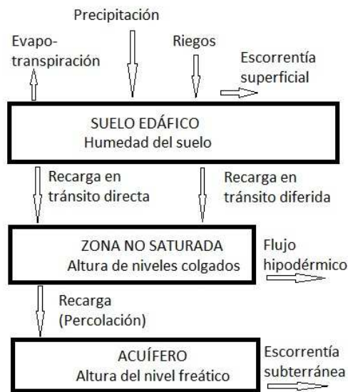
Figura 8.1. Esquema de los principales componentes del balance hidrometeorológico en el suelo edáfico, la zona no saturada y el acuífero (Samper et. al. 1997).
