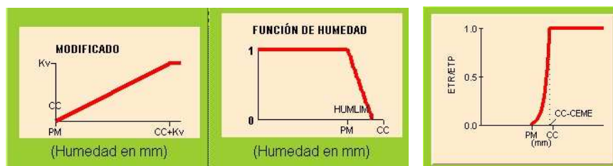
Figura A.7.2.b. Variación del flujo de salida de la zona edáfica con el contenido de humedad del suelo y función de humedad respecto al contenido en humedad del suelo y relación del coeficiente de la evapotranspiración real y potencial en función del estado de humedad del suelo para la SZ3 (PM: punto de marchitez, CC: capacidad de campo, Kv: conductividad hidráulica vertical y CEME: coeficiente de déficit hídrico).
