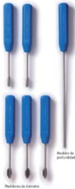
Figura 24. Medidor de profundidad y diámetro
