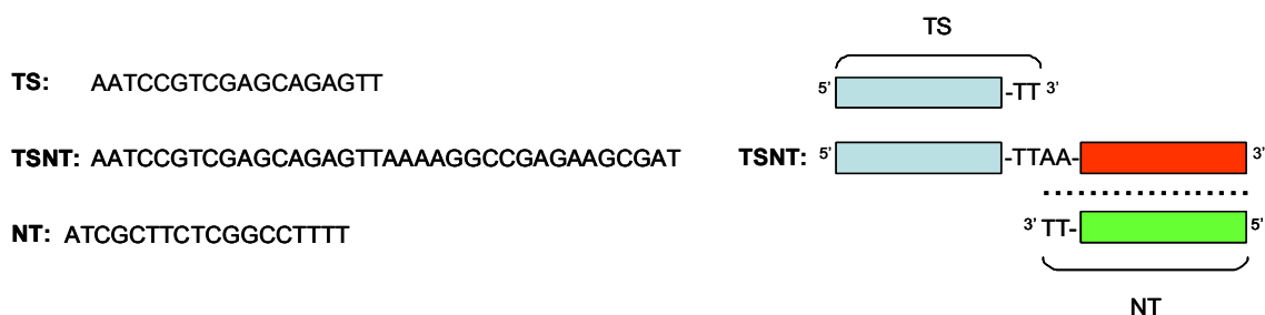
Figura 2.28 – Seqüències de TS , TSNT i NT . Com es pot observar, TSNT està format per la seqüència TS en el seu extrem 5' i per la seqüència complementària de NT en el seu extrem 3'. D'aquesta manera TSNT és amplificat gràcies a ambdós iniciadors ( TS i NT ).
