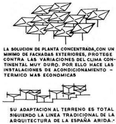
Fig. 8 y Fig. 9 Primer premio. Esquemas de agrupación de los módulos en forma de seta en perspectiva (arriba) y en sección (abajo).
