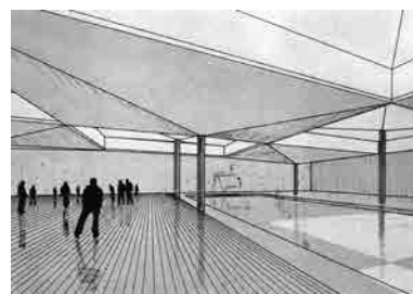
Fig. 42 Dibujo del anteproyecto de la propuesta ganadora del concurso para la Universidad Laboral de Madrid en el que se observa la espacialidad interior que se crea gracias a la utilización de unos módulos de hormigón armado con forma de seta.
