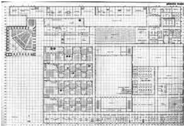
Fig. 6 Planta de la Universidad Laboral de Huesca en la que se aprecia el trazado de la malla de cuadrados de 3,6 m de lado utilizada para el dimensionado del proyecto.
