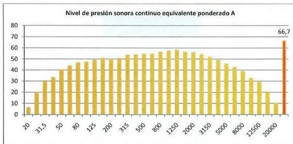
Figura 2.3: LAeq,T, de 20 a 2000Hz y en valor global, medida nº 3, formato gráfico
