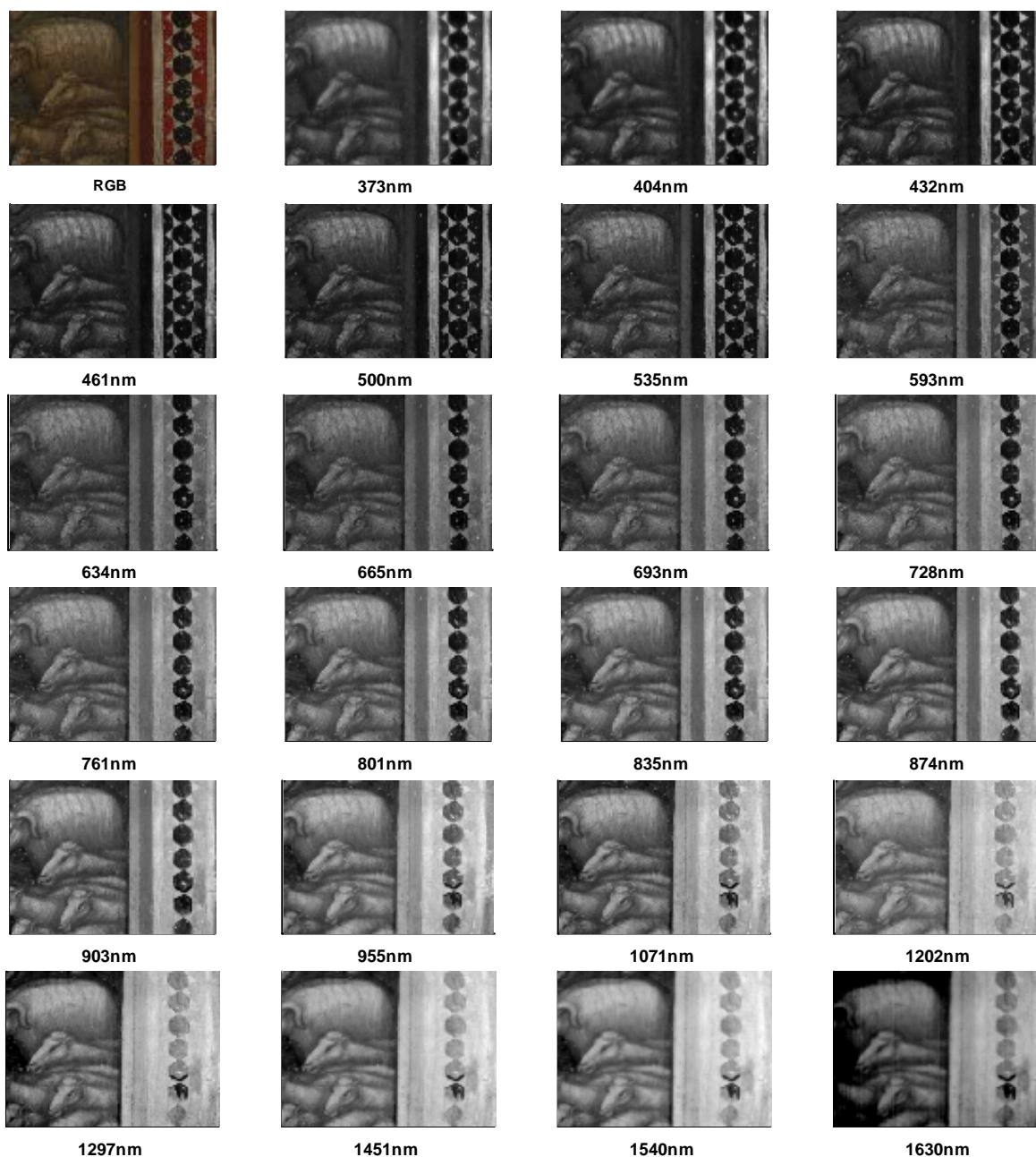
Figura 4.33 imágenes espectrales de los 23 canales que proporciona el sistema para una zona del mural de la capilla de Sant Miquel en el monasterio de Pedralbes, Barcelona
