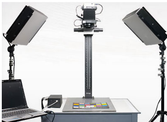
Figura 2.18 Sistema multispectral basado en iluminación LED (Tomada de http://www.mega-vision.com/about.html )
