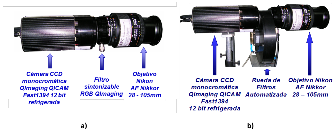
Figura 2.9 Sistemas de adquisición de imágenes basados en cámara CCD. a) Configuración colorimétrica RGB y b) Configuración multispectral con 7 canales de adquisición (de Lasarte, 2009)
