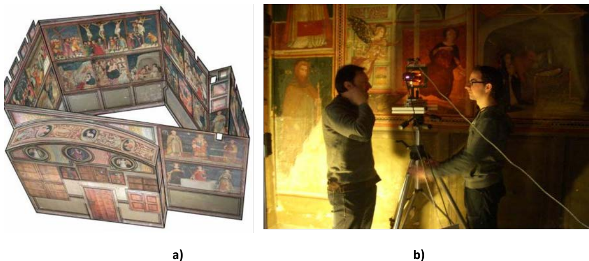
Figura 4.32 Toma de imágenes en la capilla de San Miguel en el monasterio de Pedralbes a) Esquema de distribución de las pinturas murales en la capilla b) Medición con el equipo multiespectral desarrollado en este trabajo
