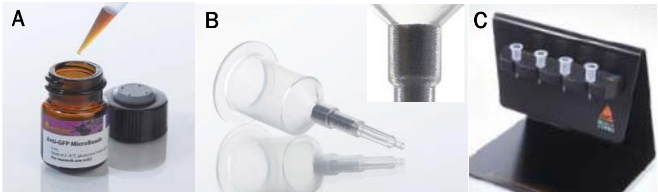
Figura M2. Sistema de purificación de proteínas μMACS™ Anti-GFP Microbeads. A. Suspensión de microesferas paramagnéticas unidas con anticuerpo anti-GFP. B. Columna empaquetada con esferas de metal. C. Soporte de metal generador de un elevado campo magnético.
