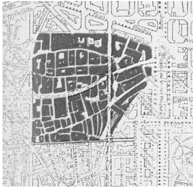
Fig. 4-12_ La prolongación de la Avd. de la Catedral y la C. Girona, previstas en el Plan Comarcal, cuarteaban la zona superior del barrio, destruyendo su estructura.
