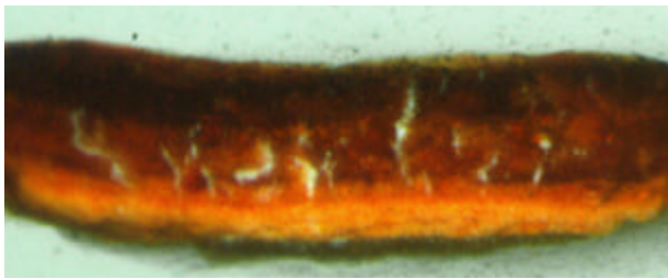
Secció transversal de les capes cromàtiques.
