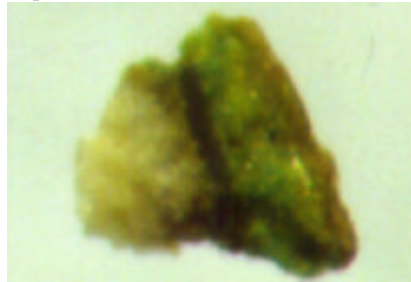
Petit fragment on s'observa tota l'estratigrafia
