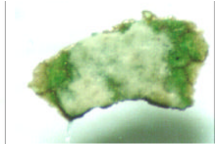
Revers. La capa blanca correspon a una capa de pigment blanc (vegeu mostra HT1) i potser a restes de la preparació de guix.
