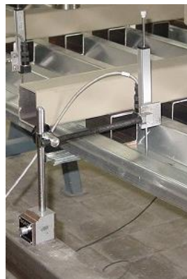
Figura 7.6. Captador de desplazamientos.
