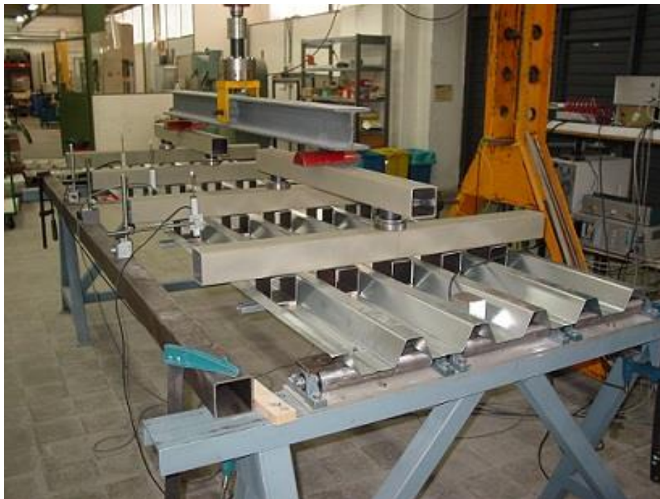
Figura 7.31. Montaje de los ensayos experimentales a flexión pura positiva.
