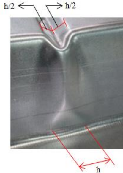
Figura 6.67. Determinación del ancho de la embutición. Parámetro h .
