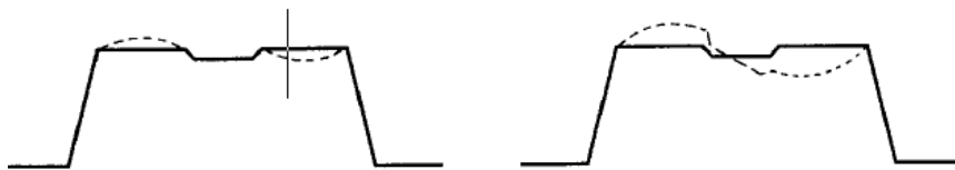
Figura B. 3. Rigidizador tipo "sombreo plano". Pandeo local asimétrico, (izquierda), y pandeo distorsional asimétrico, (derecha), (Hancock, Bernard y Bridge 1996).
