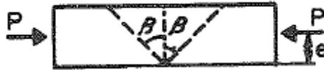
Figura 4.14. Líneas plásticas con inclinación de un ángulo \beta respecto a la carga aplicada. (Murray y Khoo 1981).
