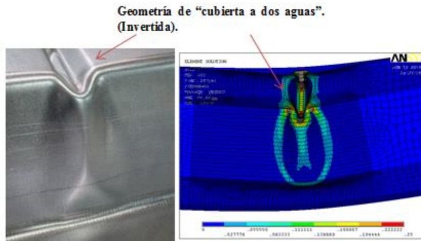
Figura 6.66. Similitud entre la geometría de la embutición y el mecanismo de fallo de la chapa sin embutición a flexión pura. (Imagen tomada del apartado 5.12).
