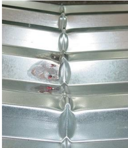
Figura 6.81. Ensayos experimentales. Mecanismo de fallo espécimen EMBT-2.
