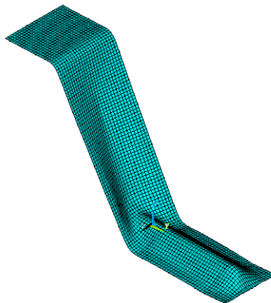
Figura 5.8. Simulación del proceso de conformado. Obtención de la geometría de la embutición.
