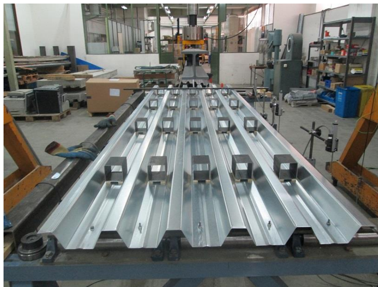
Figura 7.29. Disposición de tacos de acero, (80.80.4), y madera (100x25x8), para la aplicación de la carga.
