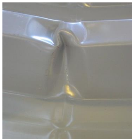
Figura 5.110. Patrón de colapso observado en los ensayos experimentales del 2006
