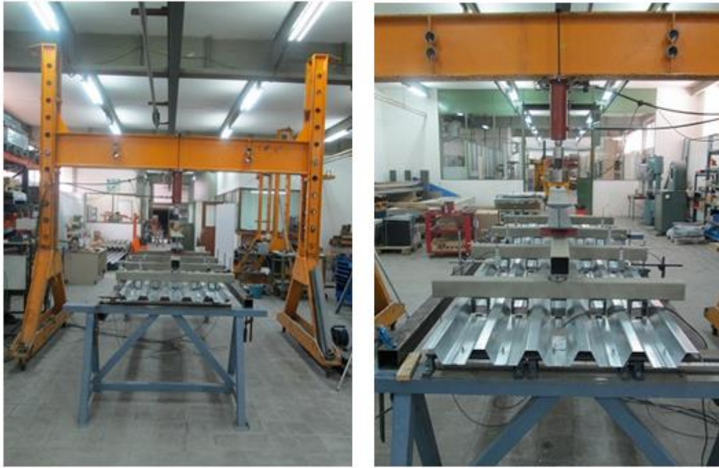
Figura 7.30. Montaje de los ensayos experimentales a flexión pura positiva.
