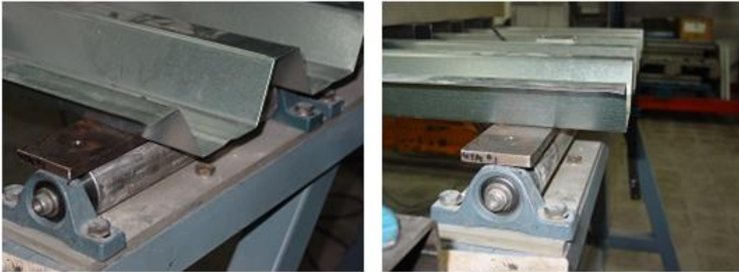
Figura 7.33. Detalle de los apoyos.
