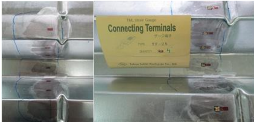
Figura 7.26. Posición de las galgas en el espécimen PLANA-2. Cara inferior del panel nervado.
