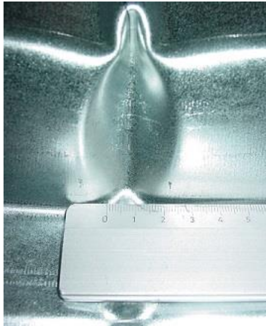
Figura 7.66. Medición del ancho de la rótula. Mecanismo de fallo de los paneles con embutición.
