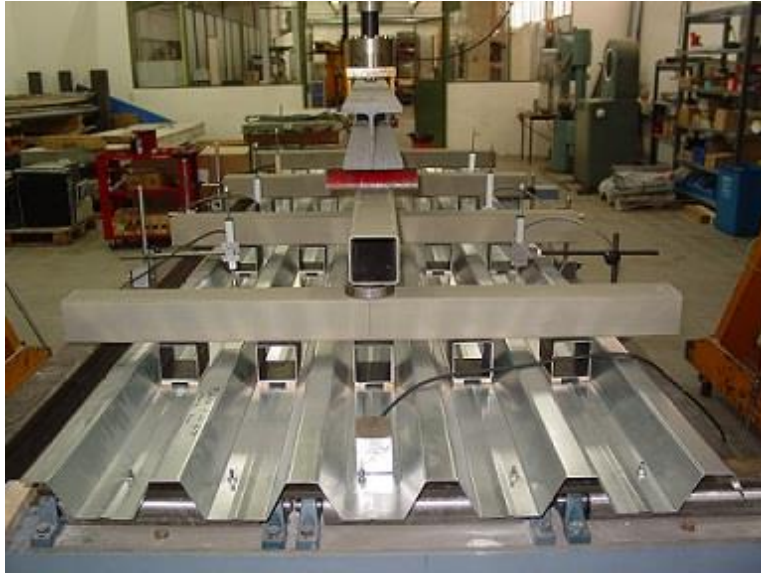
Figura 7.32. Montaje de los ensayos experimentales a flexión pura positiva.
