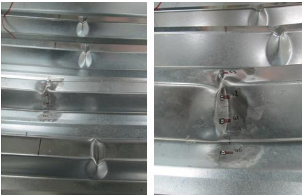
Figura 7.37. Mecanismo de fallo en el espécimen PLANA-2.
