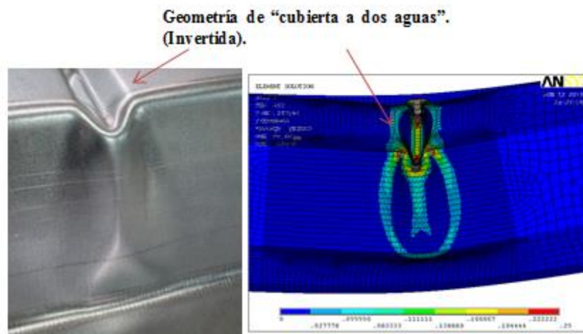
Figura 5.269. Geometría de la embutición Vs. Patrón de colapso a flexión pura positiva.
