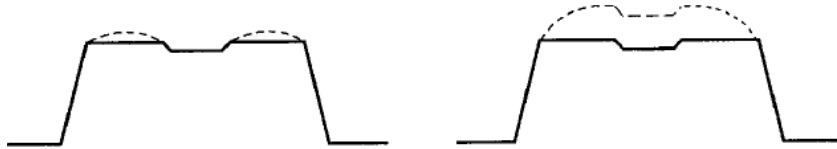
Figura B. 2. Rigidizador tipo "sombrero plano". Pandeo local simétrico (izquierda), y pandeo distorsional simétrico, (derecha), (Hancock, Bernard y Bridge 1996).
