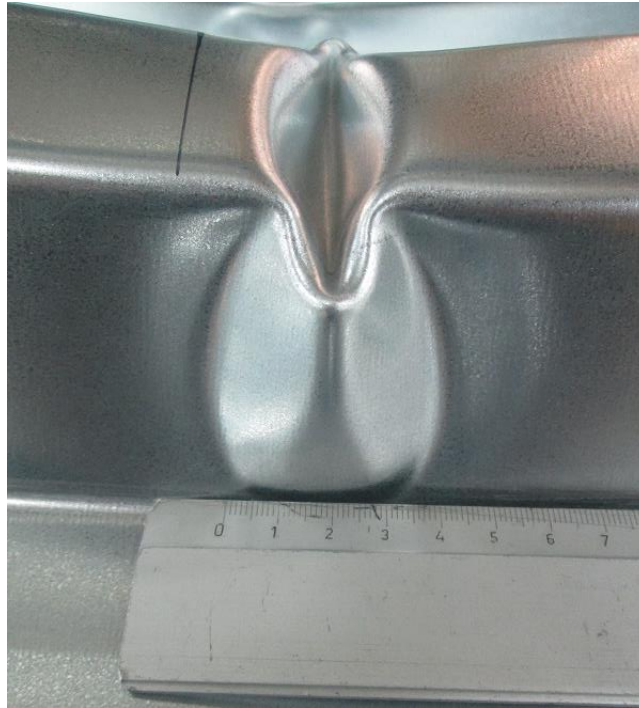
Figura 7.38. Medición del ancho del mecanismo de fallo del espécimen PLANA-2.
