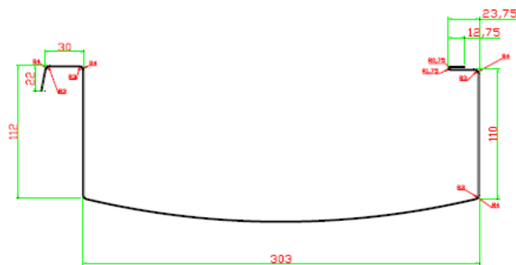
Figura 2.51. Sección en "U", ( www.archconstruction.ru/data/Chine_machines.pdf ).
