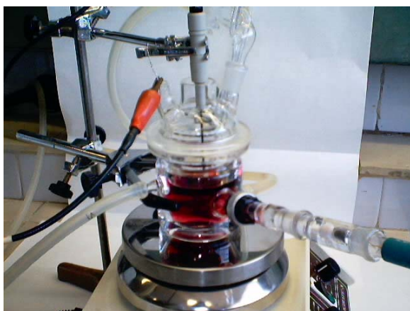
Cel·la termostatitzada de tres elèctrodes
