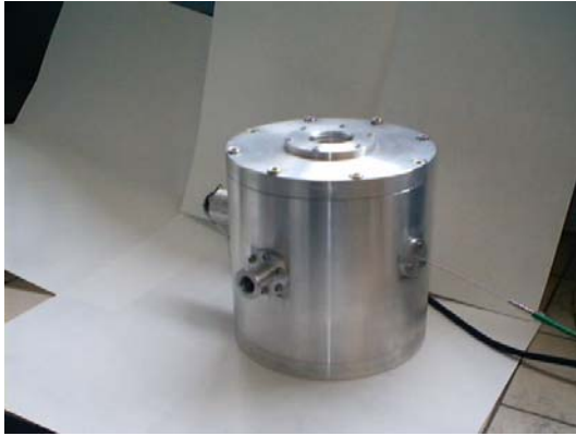
Forn per el tractament tèrmic de les mostres
