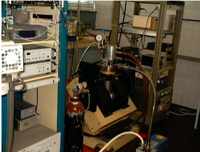
Sistema de mesura de la magnetoresistència
