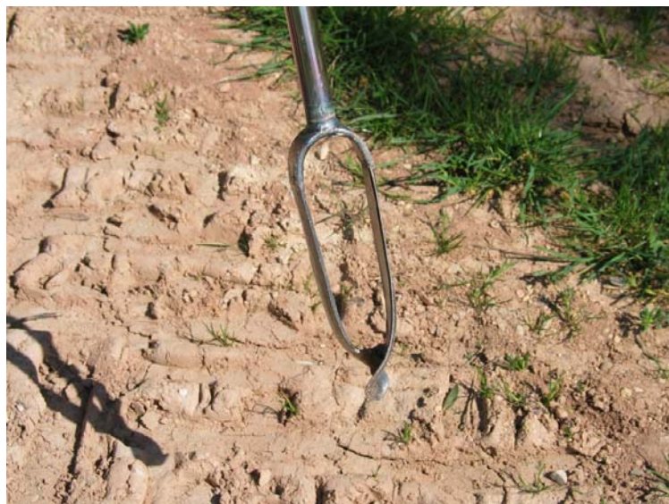
Figura 3.11. Barrina Edelman utilitzada en el mostreig de sòls agrícoles
