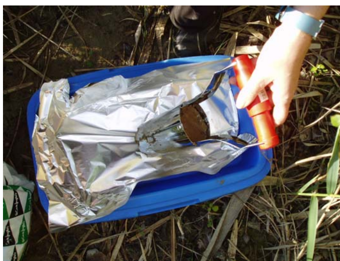
Figura 5.5. Perforador metàl·lic utilitzat en el mostreig de sòls
