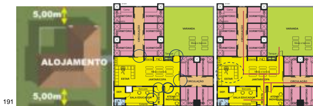
ILUSTRACIÓN 122: VISTA AÉREA DEL MÓDULO DE ALOJAMIENTO Y SU SECTORIZACIÓN INTERNA DE LOS ACCESOS
