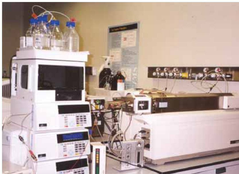
Figura 16: Espectròmetre de masses triple quadripol API 3000 amb font d'ionització electrospray.
