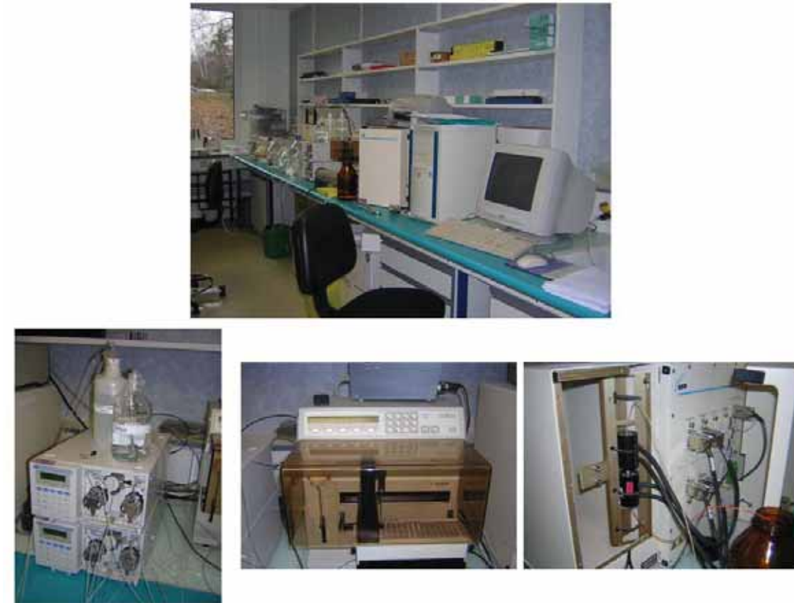
Figura 20: CoulArray ( model 5600, Eurosep, Cergy, Francia) amb les seves bombes, injector i electrodes en sèrie
