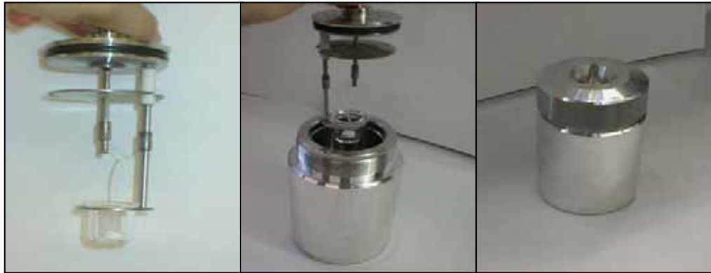
Figura 4. Esquema del muntatge de la bomba o obús
