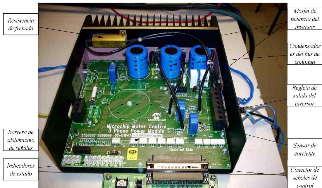
Figura 8.5 Vista de la placa de potencia.
