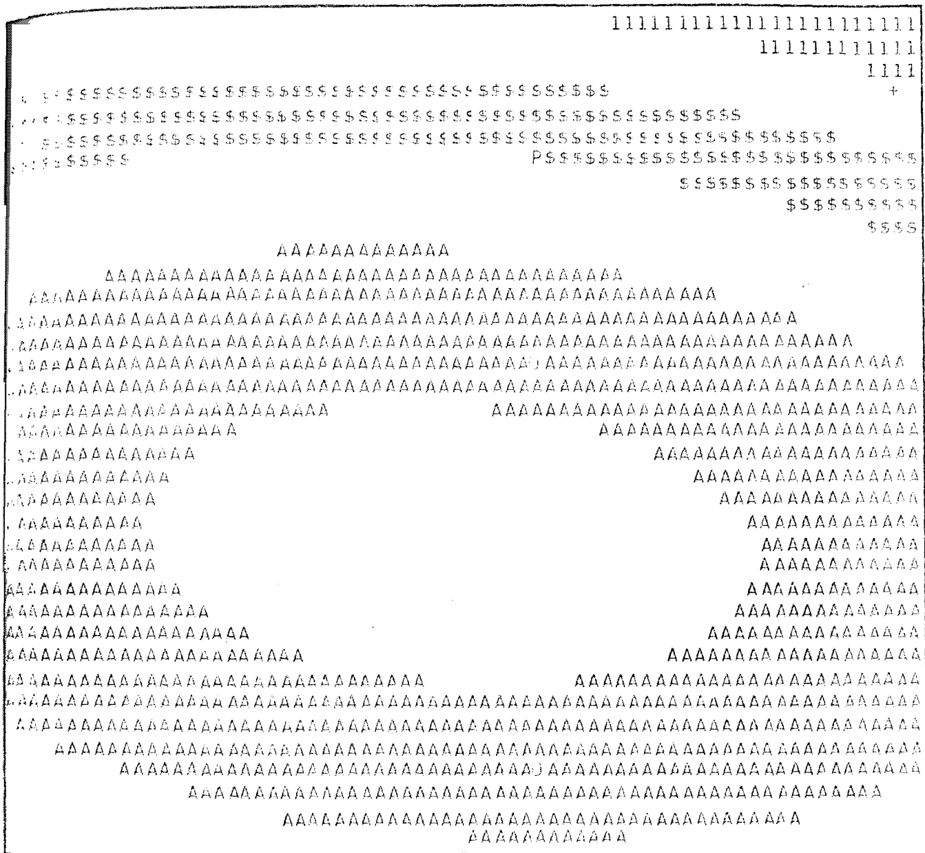
Figura 79. Superficie de segundo grado obtenida para el cobre por ajuste polinómico utilizando la salida gráfica en impresora.
