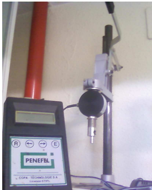
FIGURA 3.10: Penetrómetro utilizado para las medidas de dureza interna.
