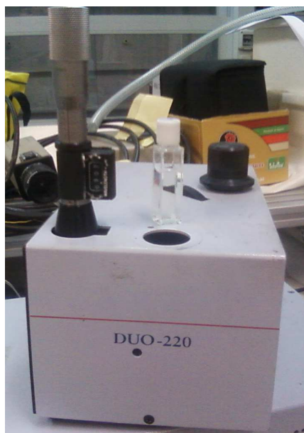
FIGURA 3.3: Plataforma para colorantes con tornillo micrómetro.
