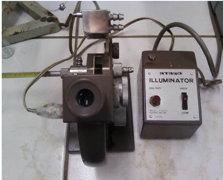
FIGURA 3.9: Refractómetro utilizado para las medidas de grados Brix.
