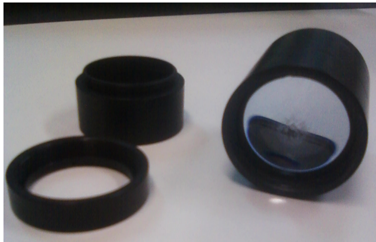
FIGURA 3.5: Lente y acoples usados en la configuración de transmisión.
