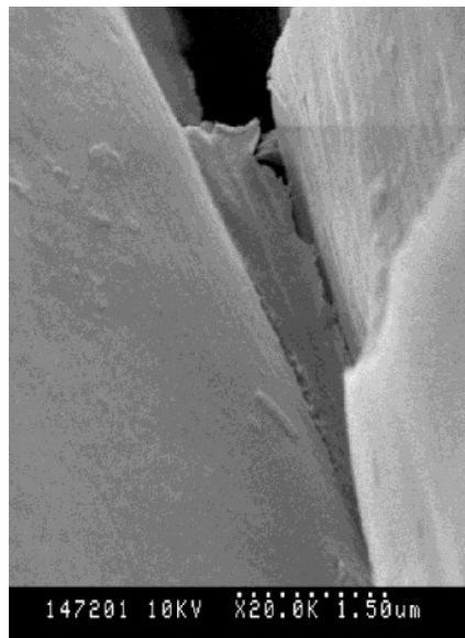
Figura 4.20. Fotografía de microscopía electrónica de barrido de fibras de lana tratadas con plasma de aire (100 W, 2 min) y posteriormente tratada con 10% s.p.f. QS (Erra y col., 1999b).
