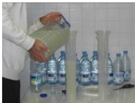
Figura 6. Proceso para la medición de 1000 ml. de agua y preparado que se vertió en los recipientes.
