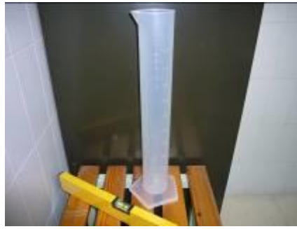
Figura 7. Superficie nivelada donde se apoyó la probeta.
