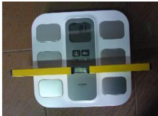
Figura 3. Nivelación de la balanza utilizada en la investigación.
