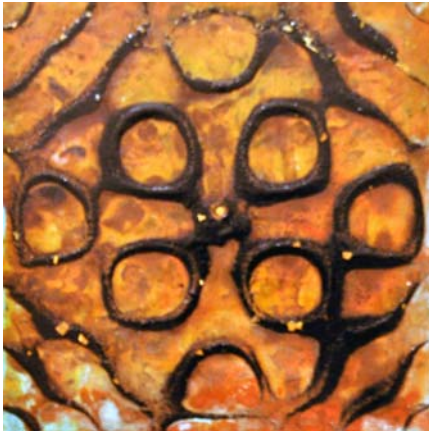
< Figura 162. Esta imagen muestra una plancha de cobre sobre la que se ha generado un dibujo y se ha fijado mediante betún de Judea. Las líneas de formación sobre una plancha desnuda quedan muy bien definidas y apenas aparecen imperfecciones. Imagen del autor.
