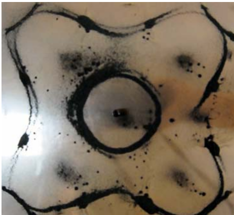
< Figura 158. Plancha de cobre de 20x20 cm. y 0.5 mm. de grosor en la que se ha aplicado una frecuencia de 480Hz. Observamos como las partículas de betún se depositan en las zonas nodales, aunque se generan residuos por la superficie en forma de pequeñas aglomeraciones en los anti-nodos. Estas pequeñas impurezas pueden ser limpiadas mediante un pincel de pelo fino para acuarela. Una vez el betún está depositado, su alto nivel de adherencia actúa como un refuerzo y evita la deformación de las estructuras al ser retirada del generador de ondas. Imagen del artista.
