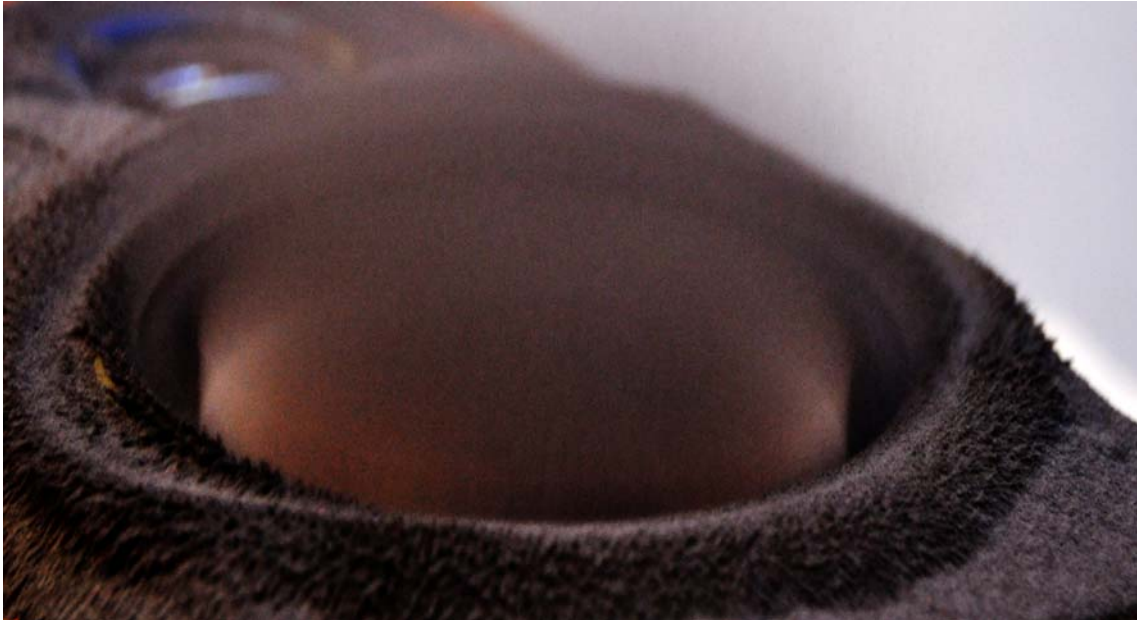
Figura 46. Podemos observar como el hierro puede comportarse como un sólido o permanecer en una especie de estado gaseoso, en el que las partículas forman densas nebulosas. Estas cesan cuando deja de actuar la oscilación. En la zona exterior del cono, se deposita parte del material expulsado y se hacen visibles las estructuras magnéticas originadas debido a la carga que adquieren las partículas por fricción. Imagen del autor.
