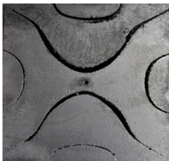
< Figura 160. Esta imagen muestra una plancha de Zinc en la que se ha generado un dibujo diferente y se ha sometido al mismo proceso de calentamiento. En este caso la plancha se ha tratado con suavidad y no aparecen desconchamientos sobre la superficie de las líneas ya fijadas. 20x20 cm. y 1mm. de grosor. Tono de 740Hz. Imagen del autor
