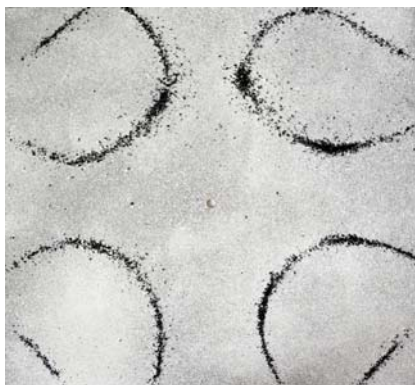
< Figura 167. Plancha de hierro de 20x20 cm. y 0.5mm de grosor sobre la que se ha aplicado una base de pintura mediante spray negro. Se ha esparcido una capa uniforme de azúcar sobre la superficie y se ha aplicado una frecuencia de 460Hz. Una vez creada la figura, se ha realizado otra imprimación mediante spray de color blanco. La utilización de agua caliente, permite que el azúcar se disuelva mostrando la capa base original que hace visible la figura. Imagen del autor.
