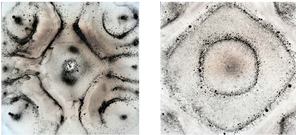
Figuras 161. En la siguiente imagen podemos observar dos planchas que se han sometido a un proceso de fijación mediante calor con betún de Judea en polvo. En la primera, se aprecian manchas oscuras sobre la superficie blanca de la pintura, que son el resultado del excesivo calentamiento en esa zona, originado por las llamas del quemador. Por el contrario, en la foto de la derecha observamos como el proceso apenas ha sufrido contratiempos mediante el proceso de fijación por calor realizado en un horno precalentado a 200°. Ambas figuras son de hierro galvanizado con una base de pintura blanca mediante aerosol. Las planchas son de 20x20 cm. y 0.5 mm. de grosor, con unas frecuencias de 490Hz y 580Hz. Imágenes del autor.
