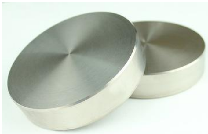
Figura 2.4: Discos de Titanio comercialmente puro, de 9 mm de diámetro y entre 2 y 3 mm de espesor, obtenidos por corte con disco de diamante.
