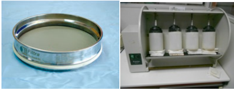
Photo 1: Filters and milling equipment used, Sieve UNE 7050-3
