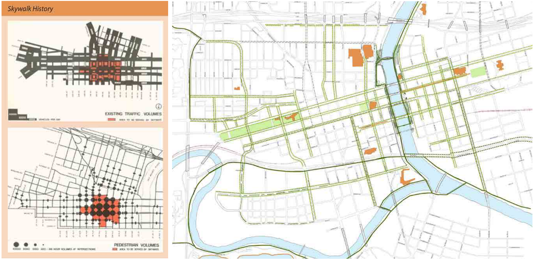
fig. 5.82 En las imágenes algunos esquemas de documento Skywalks and Sidewalks. A la derecha los análisis de los flujos de tráfico que sirvieron para la construcción del sistema de skywalks redactados por Barton and Aschman, Associates, Inc. en Agosto del 1978. A la izquierda el mapa de las calles interesadas en el proyecto de renovación para mejorar las experiencias de los peatones.
