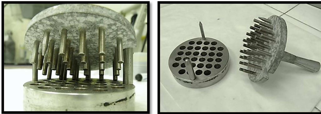
Imatge 5.2. Replicador per la sembra de fongs en placa
