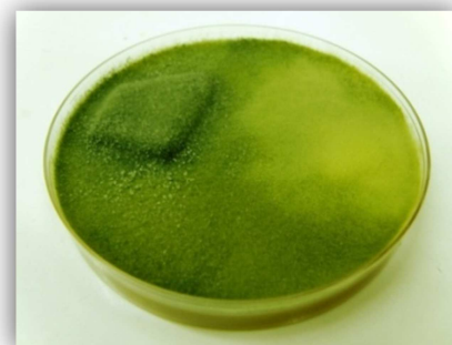
Imatge 2.1. Trichoderma harzianum sobre placa amb medi de cultiu i una mostra de pell wet blue
