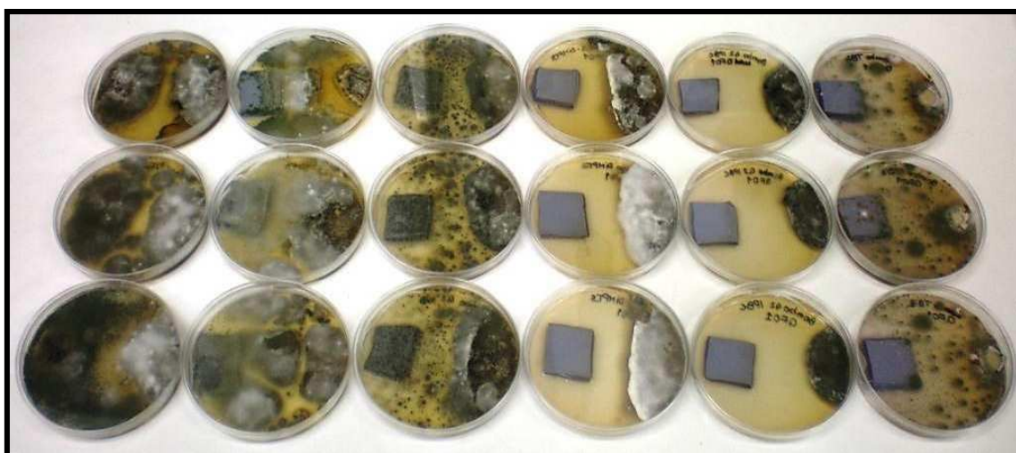
Imagen 2. Control de crecimiento de hongos QF01 sobre piel wet blue después de 90 días de incubación. Columna de izquierda a derecha: Control, TCMTB, Mezcla compuestos fenólicos, DIMPTS, IPBC, TBZ.
