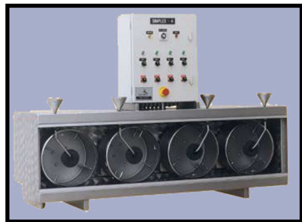
Imatge 3.2. Bombos d'acer inoxidable Inoxvic utilitzats per realitzar les diferents proves
