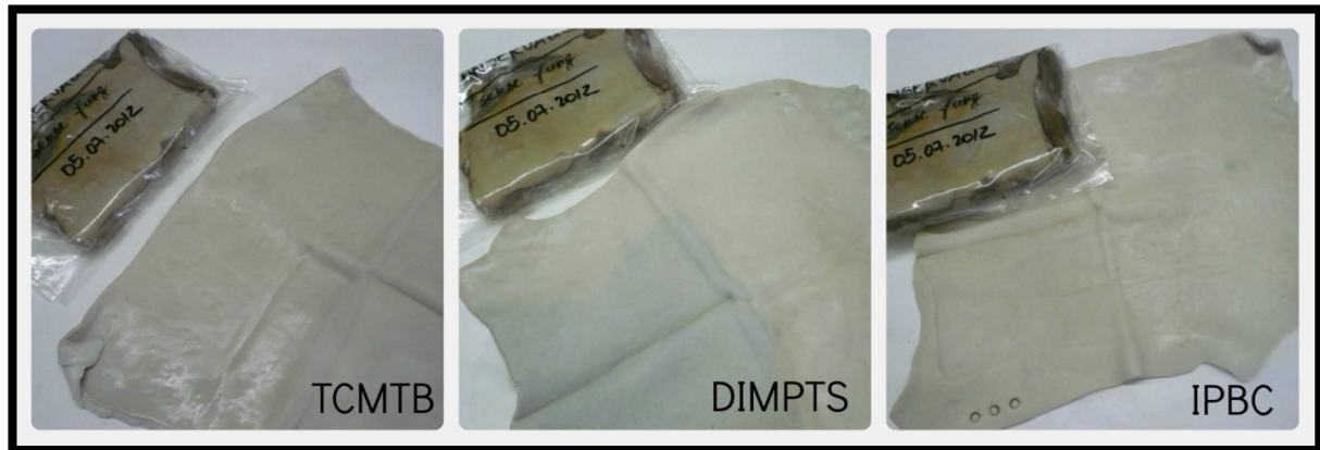
Imatge 8.11. Comparació de la pell sense fungicida amb les pells amb TCMTB, DIMPTS i IPBC, després de tres mesos d'emmagatzematge
