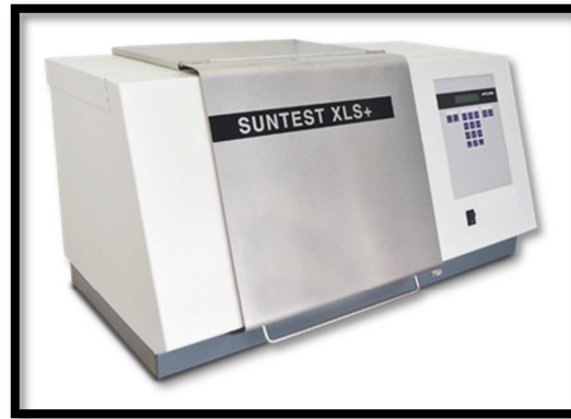
Imatge 3.6. Aparell de radiació UV utilitzat, SUNTEST XLS+
