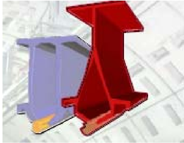
Fig 11.15 Perfil de soporte del hilo de contacto
