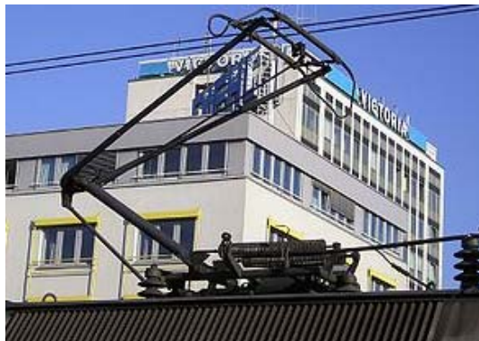
Fig. 7.2 Pantógrafo y equipo eléctrico de toma de corriente.
