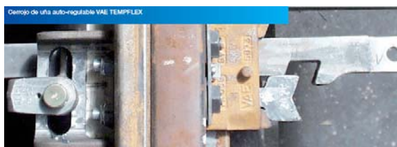
Fig.6.13 Cerrojo de uña para asegurar la inmovilización del desvío
