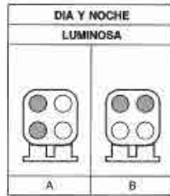
Fig. 5.17. Señal indicadora de entrada a vía directa o desviada Fuente: Reglamento General de Circulación 1993. Título 2. Señales
