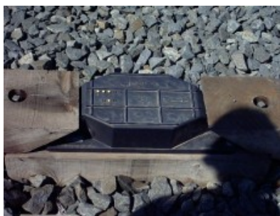
Figura 5.14. Baliza en la caja de la vía 24 .
