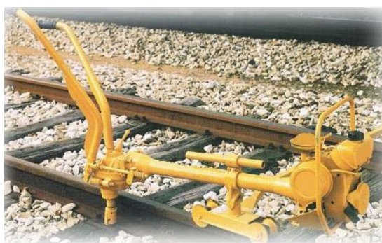
Fig. 8.7 Clavadora de tirafondos de vía
