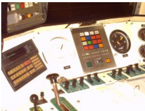
Fig. 5.13. El ASFA en el pupitre de conducción 23
