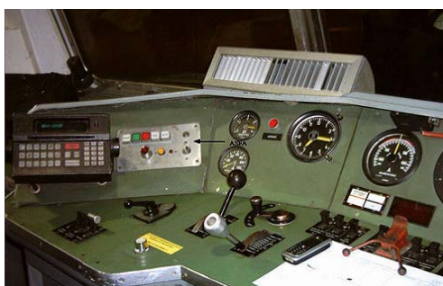
Fig. 3.1 Pupitre de cabina con el Sistema ASFA.
