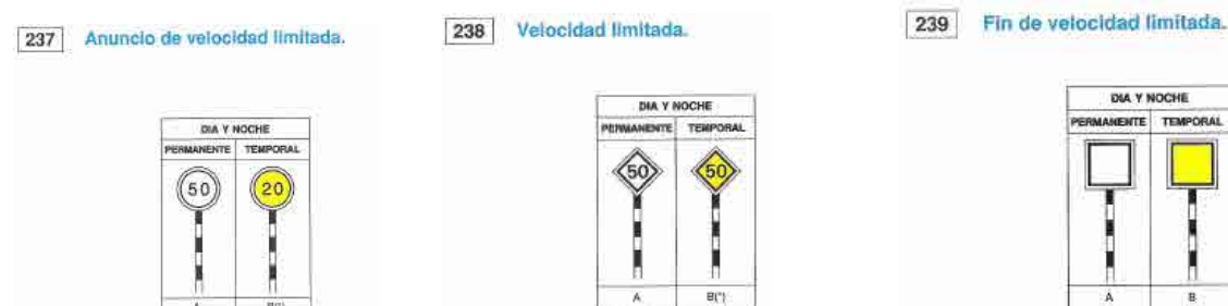
Fig. 5.21 Anuncio de velocidad limitada, velocidad limitada y fin de velocidad limitada
