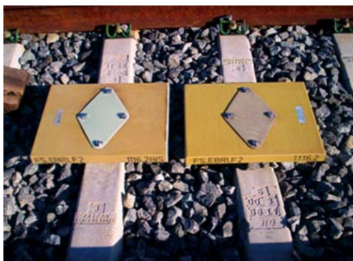
Fig. 13.4 Euro balizas Fuente: Declaración de Red ADIF. 2009
