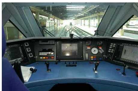
Pupitre de locomotora con ASFA DIGITAL 67 .
