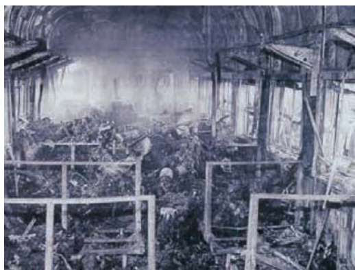
Fig. 7.7 Efectos de un incendio en el interior de un coche. José Miguel La Costa. C.A.F.
