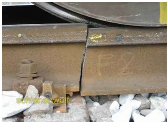
Fig. 6.20 Carril roto bajo carga
