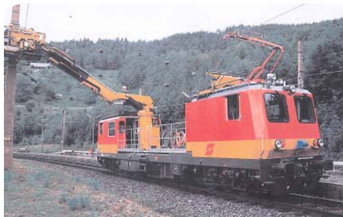
Fig. 11.13 Maquinaria de mantenimiento de vía electrificada Fuente: Información de la casa Pleasser en revista VÍA LIBRE
