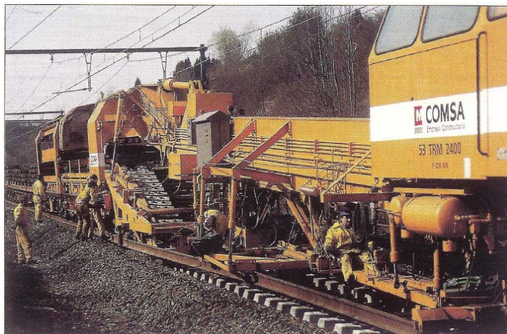
Fig. 6.24 Tren de renovación rápida de la casa Matisa.
