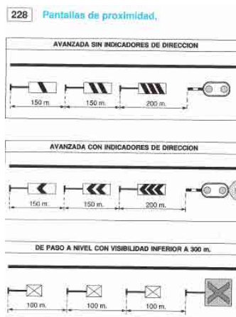
Fig. 5.18. Pantallas de proximidad de una señal avanzada Fuente: Reglamento General de Circulación 1993. Título 2. Señales
