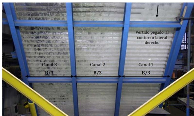
Figura 70. Vista posterior de la expansión lateral respecto al llenado de los escalones. Ensayo  $b_0/B=1/3$  y  $(y_c/h)_e=1.14$ .
