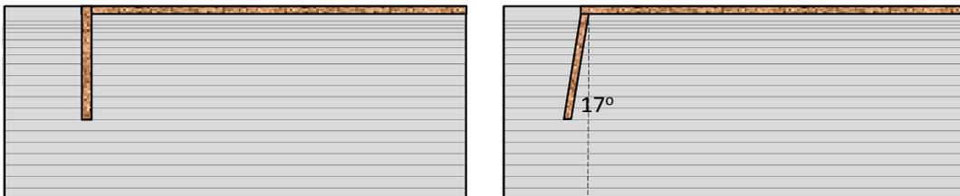
Figura 58. Esquema acompañamiento paralelo al eje y acompañamiento convergente.
