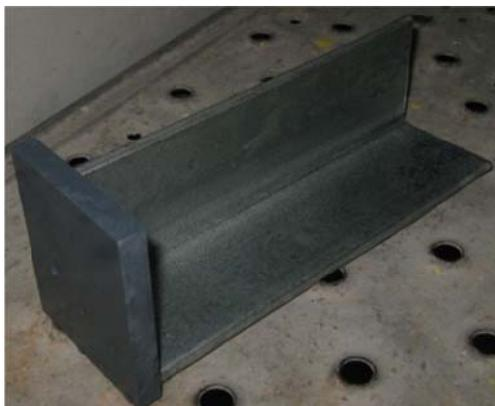
**Figura 61. Tabiques con perfil en L de contrapeso para evitar el arrastre del flujo.**
