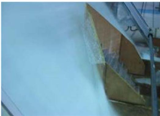
**Figura 150. Funcionamiento del muro recogida 1.  $(y_c/h)_e=1.14$ .**
