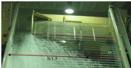
**Figura 191.** Expansión lateral observada en el modelo físico.  $(y_c/h)_e=2.37$ .
