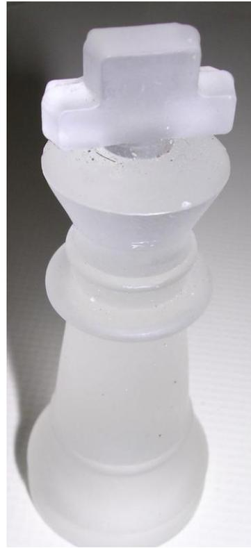
Se puede denominar cristal esmerilado o cristal opacado, esta técnica se produce gracias al granallado o el grabado de ácido del vidrio claro. Los resultados son convertir el cristal de transparente a translúcido por la dispersión de la luz durante la transmisión, esto crea un efecto nublado de las imágenes que se observen a través de él.
