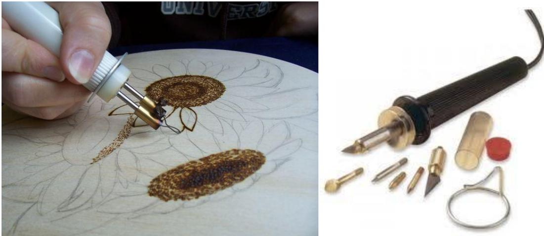
El pirograbador es una herramienta que se utiliza para grabar en madera, tela o piel, se trata de una especie de punta de metal que se calienta mediante suministro eléctrico como si de un soldador se tratara<sup>298</sup>.
