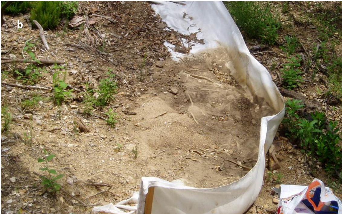
Figura 7. a. Instalación de una trampa “siltfence” en un área de alcornoques gestionada mediante el PTMGF. b. Sedimento atrapado en la trampa (20/2/2007).
