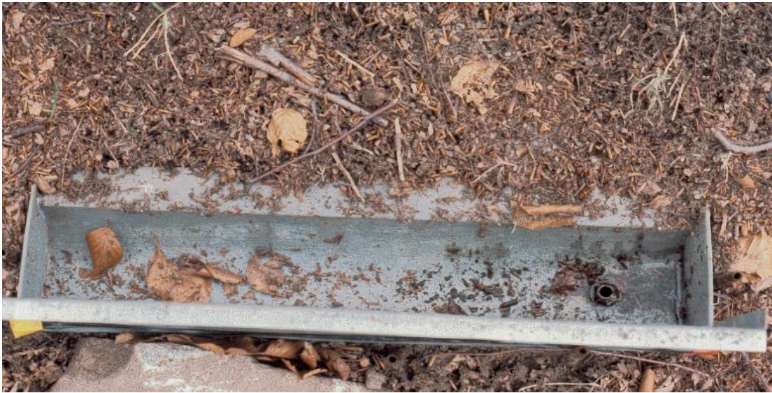
Figura 1. Trampa de sedimento tipo Gerlach para la medida de la erosión en vertientes (bosque y campo agrícola).
